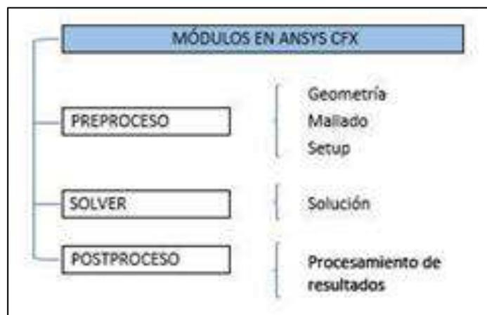
Figura A. 5. Diagrama dl flujo del programa Ansys.
