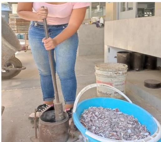
(a) Con la barra de acero en moldes de acero
