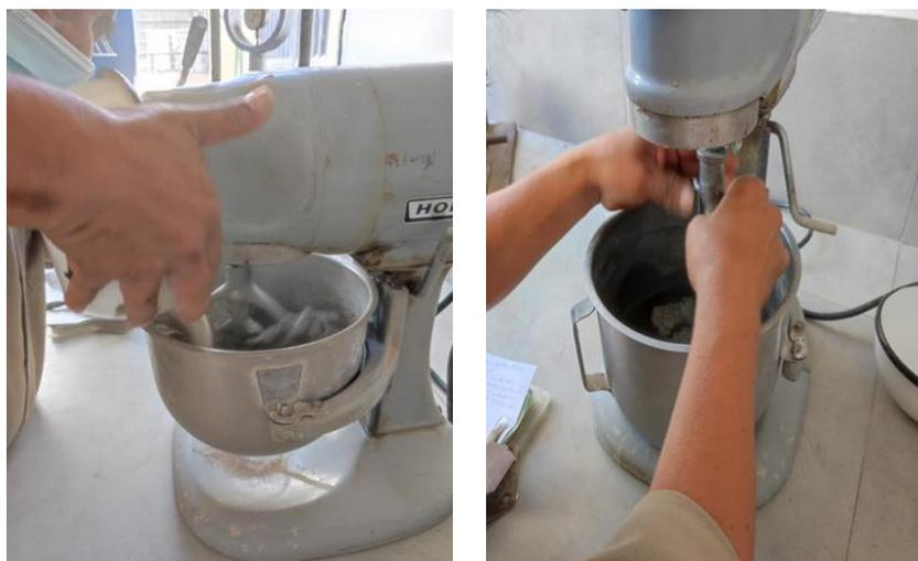
Por cada muestra se elaboraron 12 cubos de 5 cm de lado y 6 cilindros de 2" de diámetro y 10 cm de altura, que se curaron en agua durante 28 días antes de su evaluación a temperaturas elevadas (ver Figura 14). Los cubos fueron usados para los ensayos de compresión y los cilindros, para medir la absorción, ambos a 28 días de edad.
