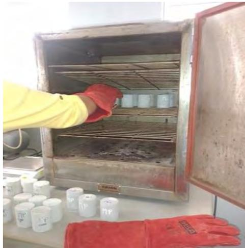
Para obtener el peso saturado después de la inmersión, las muestras se sumergen en agua por un periodo de 24 horas, pasado este tiempo se retiran y se secan superficialmente con una toalla y se procede a su pesaje.
