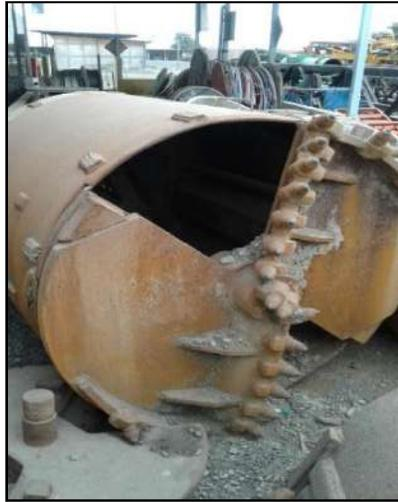
Figura 25. Vista inferior del balde de perforación
