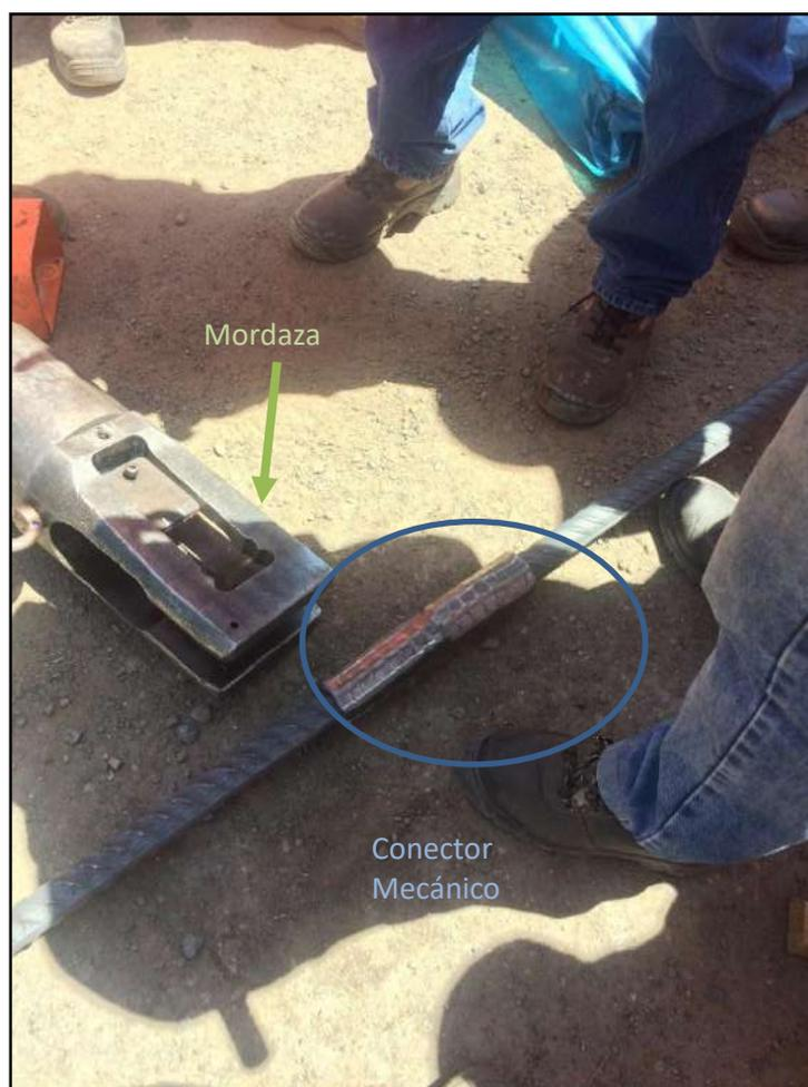
Figura 21. Varillas conectadas mediante conexión mecánica
