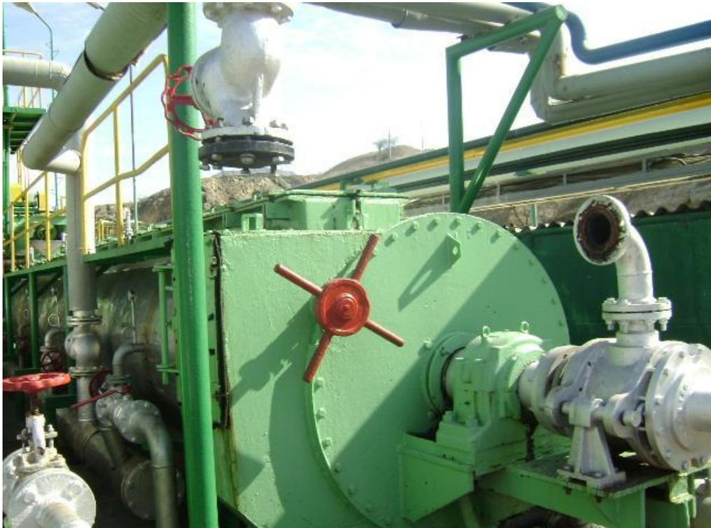
Figura 2. 6. Vista de un cocinador y junta Jhonson
