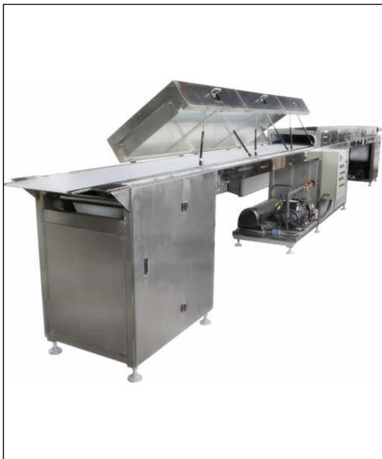
**Figura 44. Túnel de Enfriamiento de Chocolates.**
