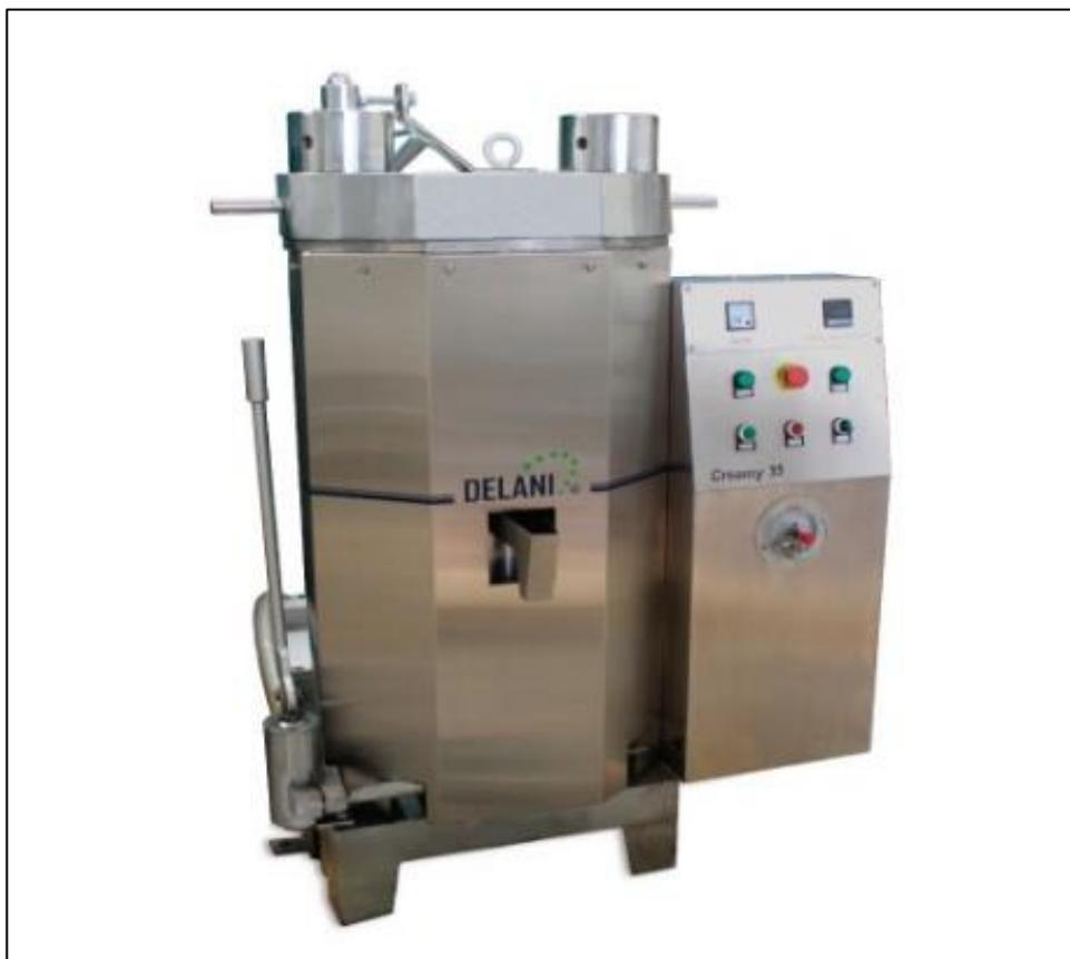
**Figura 40. Prensa Hidráulica para Manteca de Cacao.**
