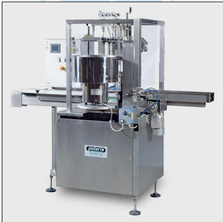
Figura 40. Monobloque de embotellado Polaris Automazioni B1.
