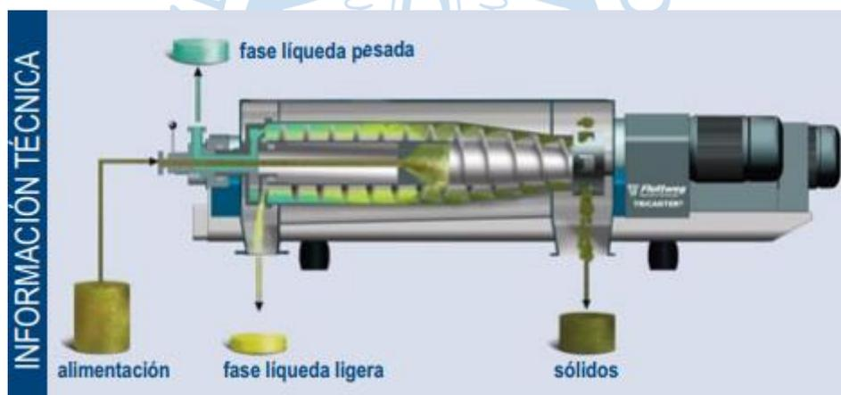
Figura 12. Flujo de los líquidos y sólidos en un Tricanter® Flottweg
