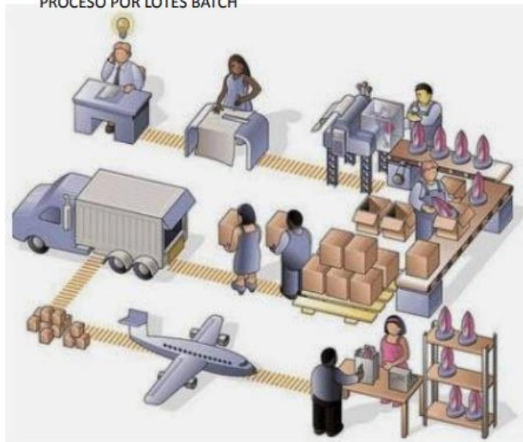
Ilustración 20: Ejemplo de producción en batch.
