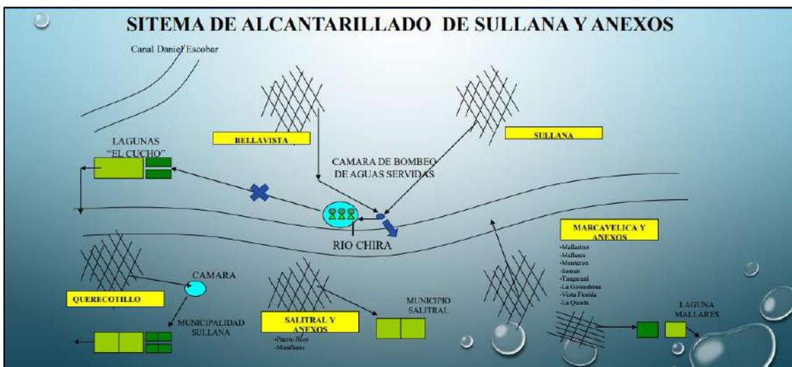
**Ilustración 2-17 Sistema de alcantarillado de los distritos de Sullana aledaños al tramo Poechos-Sullana.**
