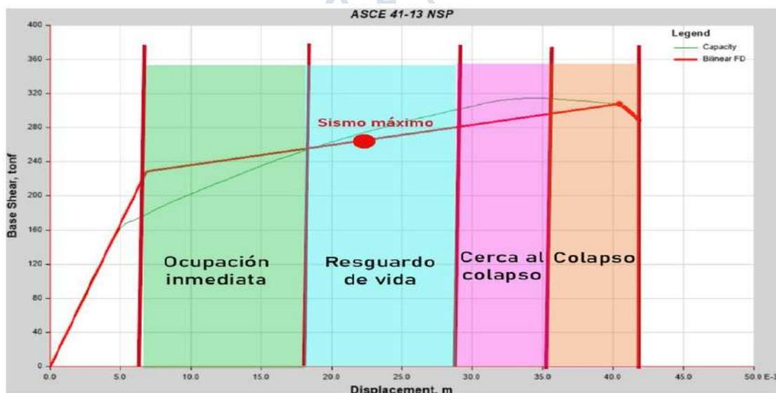
Se observa que para un sismo máximo en la dirección YY se tiene un desempeño de resguardo de vida; aun con holgura para llegar a ser cerca al colapso según VISION 2000 (SEAOC, 1995).
