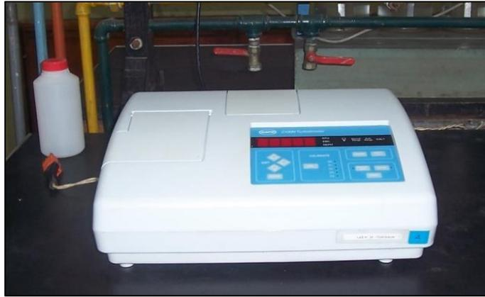
Imagen N° 44 Turbidímetro portátil 2 100 N
