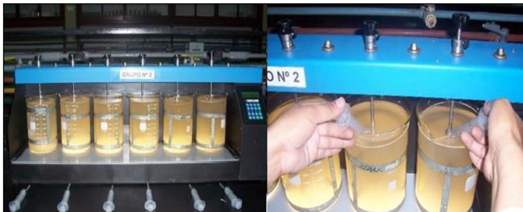
Imagen N° 47 Colocación de la solución de sulfato de aluminio en las muestras a ensayar
