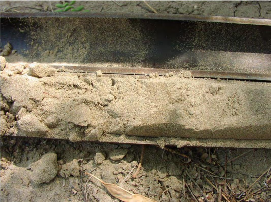
Fotografías N°3 y 4 Especímen de la arena eólica extraída con el tomamuestras del SPT.
