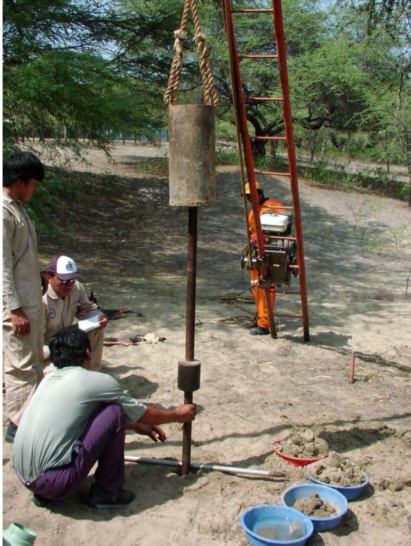
**Fotografía N°2** Ejecución del SPT (altura de caída del martillo controlada visualmente a través de una marca con tiza en la barra guía)
