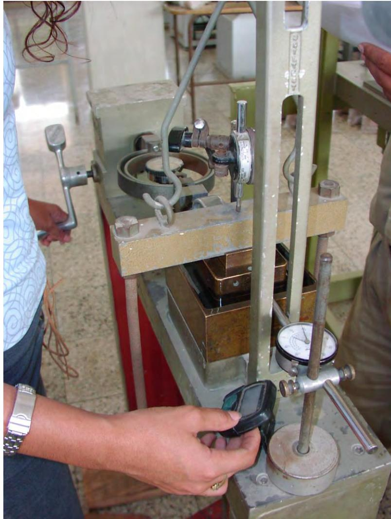
**Fotografía N°7** Ejecución del ensayo de corte directo consolidado drenado en un espécimen de arena eólica.
