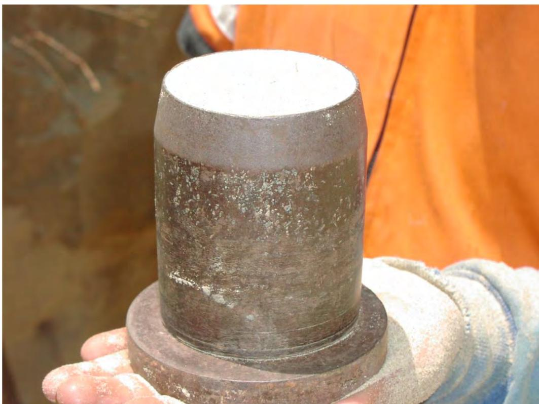
**Fotografías N°5 y 6** Medición de la densidad in situ de la arena eólica.
