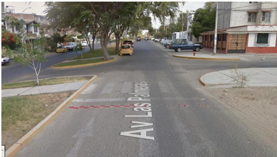
**Figura 37.** Uso de tachones en Av. Las Palmeras-Piura
