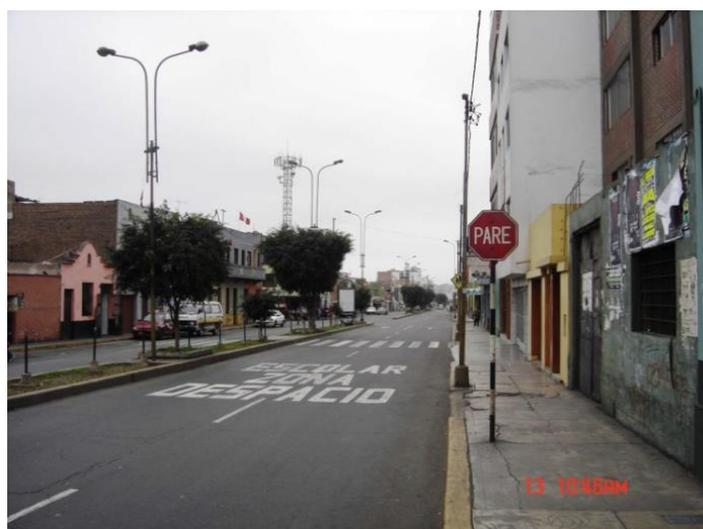
**Figura 41.** Uso inadecuado de señal de PARE obliga a detenerse y reiniciar la marcha en una avenida
