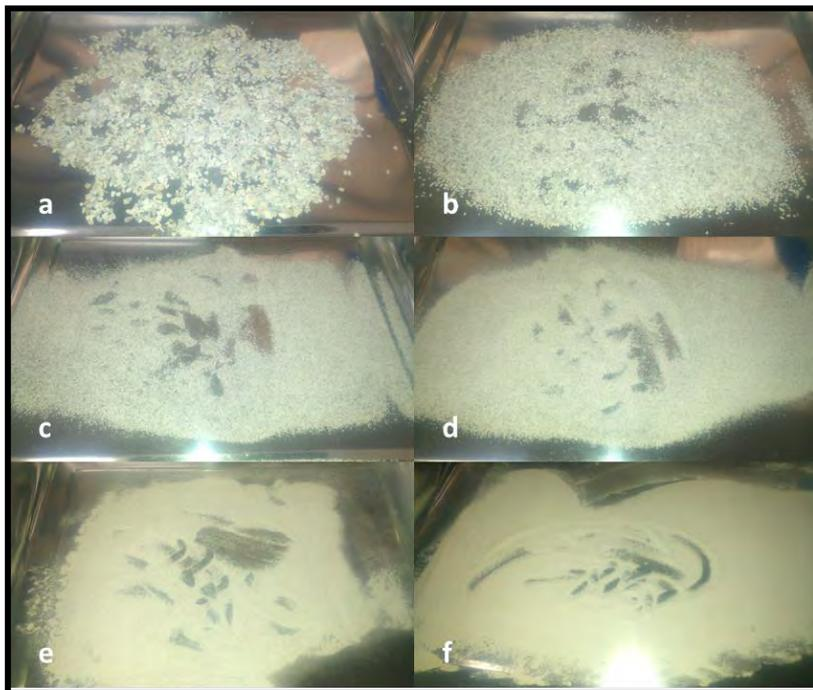
**Figura 44.** Residuos de concha pico de pato triturada, retenido en: a) Tamiz #10 (2mm abertura); b) Tamiz #20 (0.85mm abertura); c) Tamiz #40 (0.425mm abertura); d) Tamiz #60 (0.25mm abertura); e) Tamiz #140 (0.106mm abertura); f) Tamiz #200 (0.075mm abertura).
