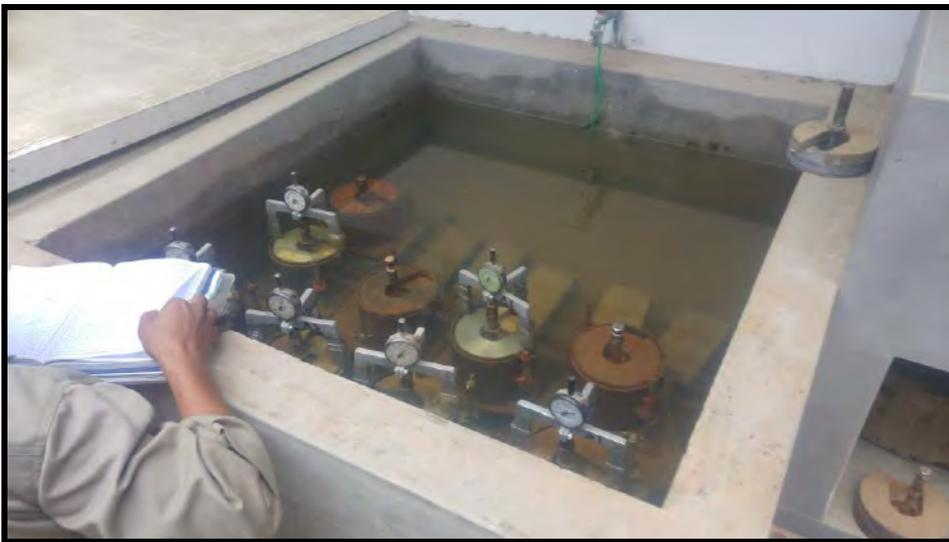
**Figura 54.** Lectura de los diales en las muestras sumergidas durante 96 horas, para medir el hinchamiento.
