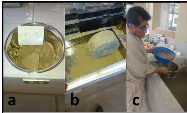
**Figura 21.** a) Muestras de suelo natural. b) Trituración del suelo. c) Lavado de muestra.
