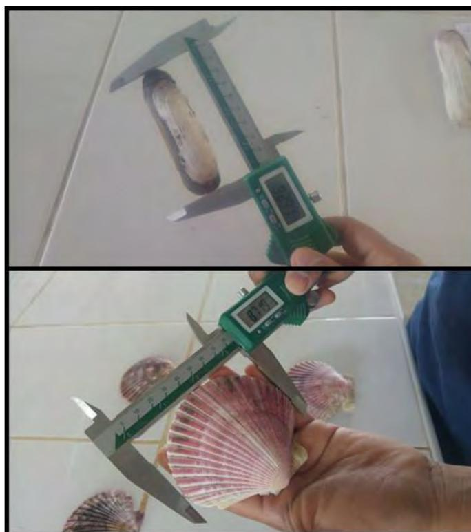
**Figura 33.** Uso del calibrador Vernier pie de rey.
