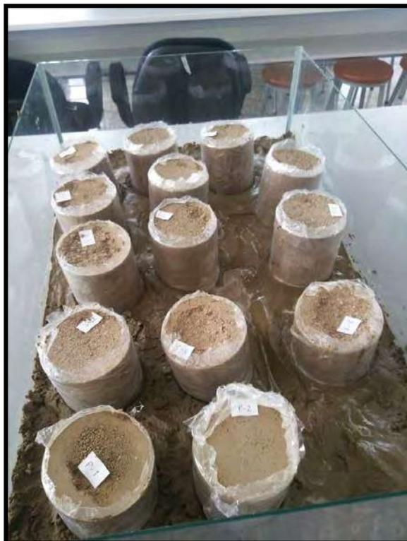
**Figura 57.** Ensayo de absorción por capilaridad. Probetas sumergidas en cama de arena saturada.
