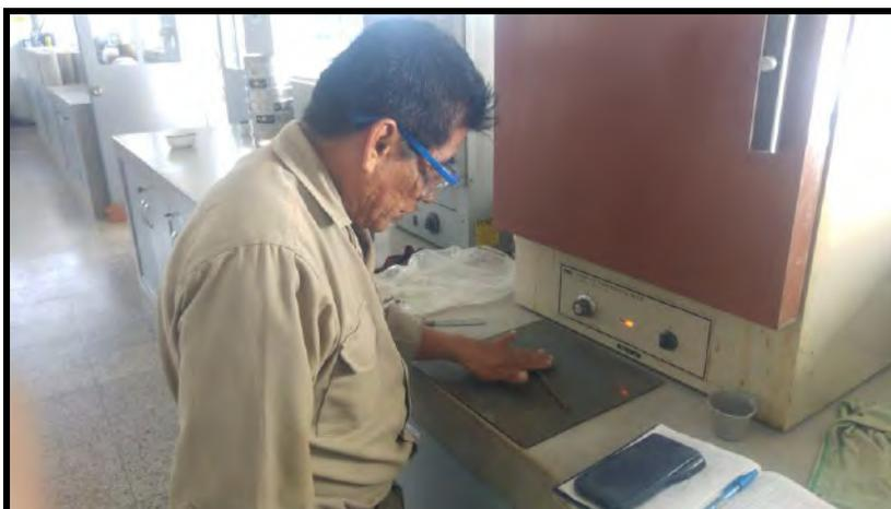
**Figura 24.** Ejecución del ensayo de límite líquido en el laboratorio.
