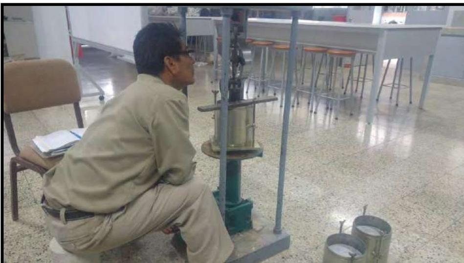
**Figura 55.** Técnico realizando el ensayo de penetración.
