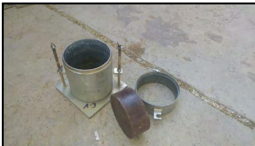
**Figura 52.** Molde usado para ensayo CBR.
