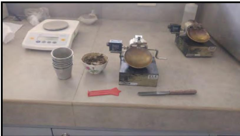
**Figura 23.** Equipo usado para el ensayo de límite plástico.
