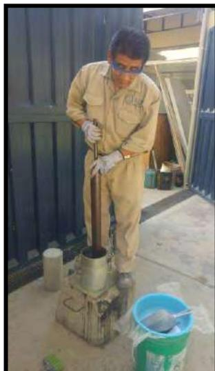
**Figura 49.** Técnico realizando la compactación por capas para el ensayo Proctor modificado.
