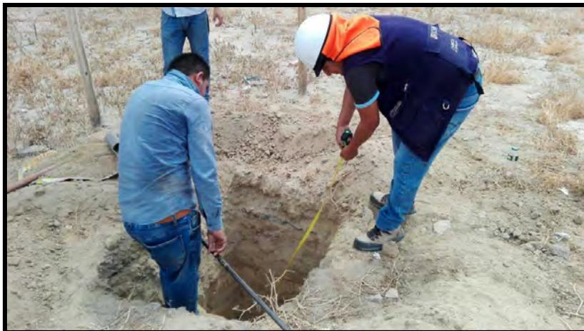
**Figura 18.** Técnicos realizando la excavación de la calicata C1.
