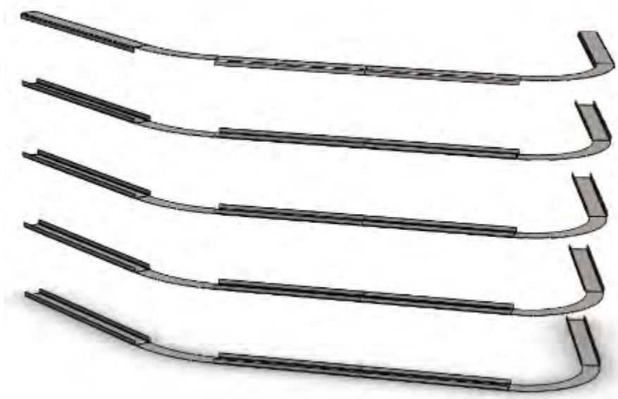
**Figura 3-20: Detalle costillas horizontales del encofrado exterior**
