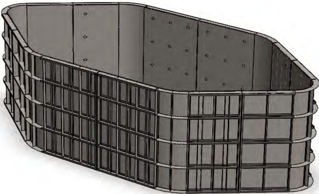
**Figura 3-23: Encofrado exterior completo**
