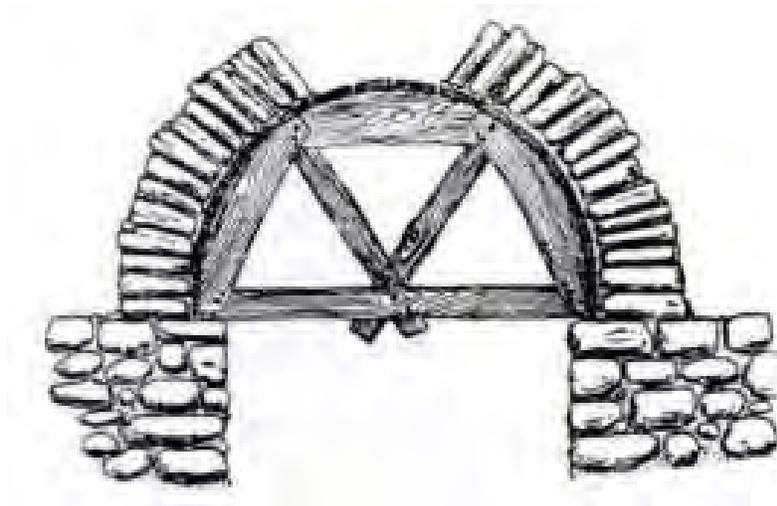
Figura 1-4: Forma o encofrado de un arco primitivo.<sup>4</sup>
