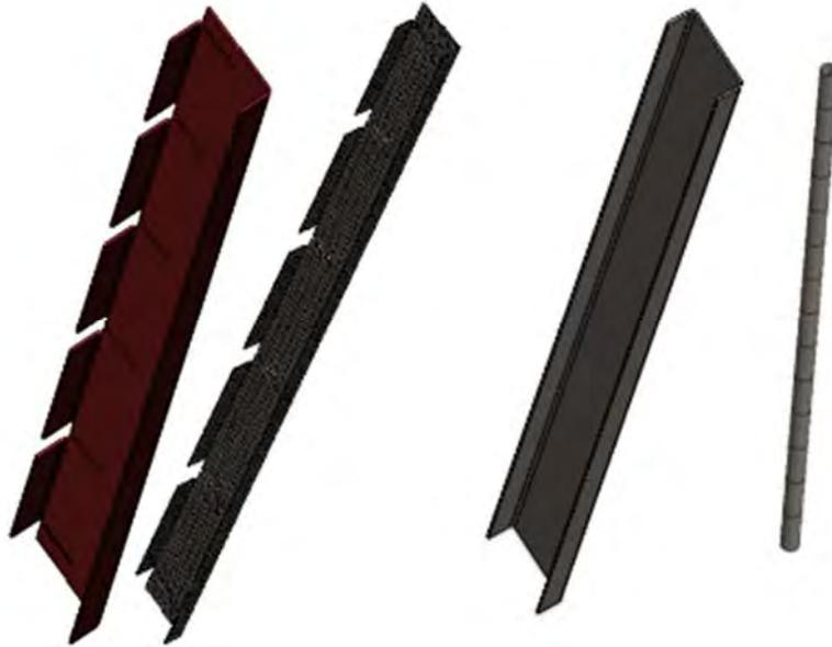
**Figura 4-2: Comparación costilla modelo constructivo (izq.) y modelo para simulación (der.).**
