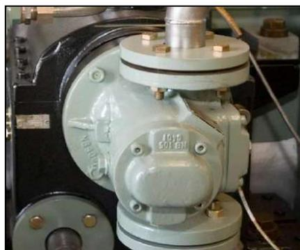
Figura 34. Bomba mecánica conectada al eje de baja rotación del reductor.
