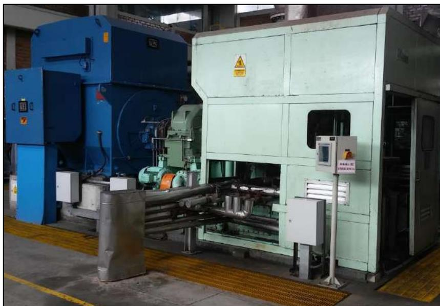
Figura 18. Turbina de contrapresión, equipo crítico.
