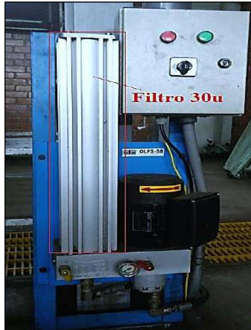
Figura 77. Filtro de 30 um montado sobre la bomba de aceite.
