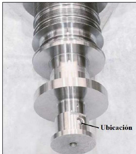
Figura 92. Imagen del rotor donde se especifica la ubicación del disparador.
