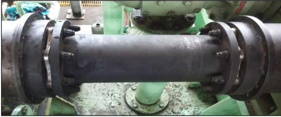
Figura 89. Acoplamiento de láminas de la turbina.
