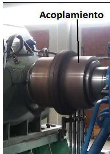
Figura 47. Acoplamiento Falk tipo metalflex 1060G.
