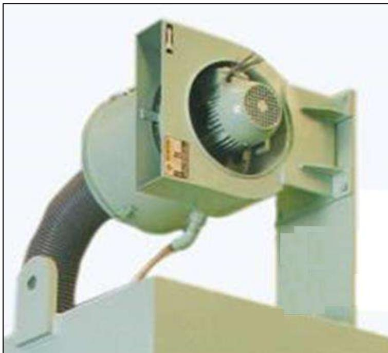
Figura 35. Imagen del extractor de niebla montado sobre el reservorio de aceite.
