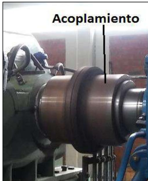
Figura 90. Acoplamiento Falk tipo metalflex 1045G.
