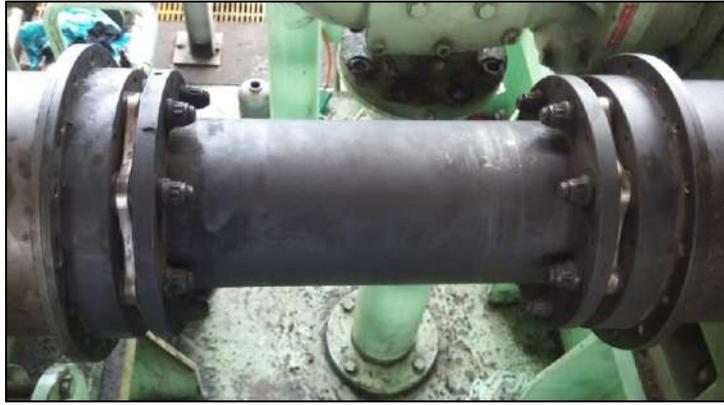
Figura 46. Acoplamiento de láminas de la turbina.
