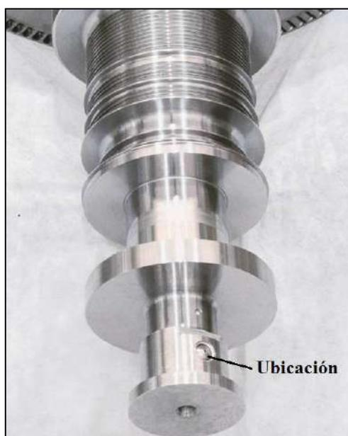
Figura 49. Imagen del rotor donde se especifica la ubicación del disparador.
