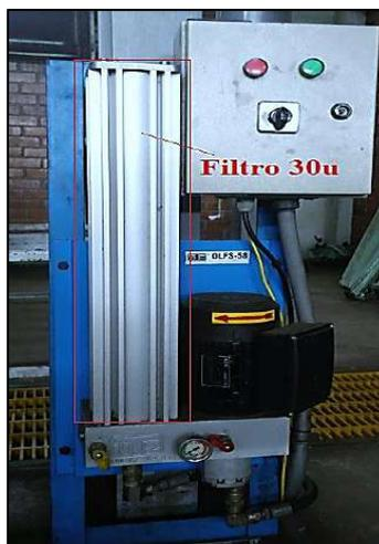
Figura 37. Filtro de 30  $\mu$ m montado sobre la bomba de aceite.
