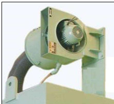
Figura 75. Imagen del extractor de niebla montado sobre el reservorio de aceite.
