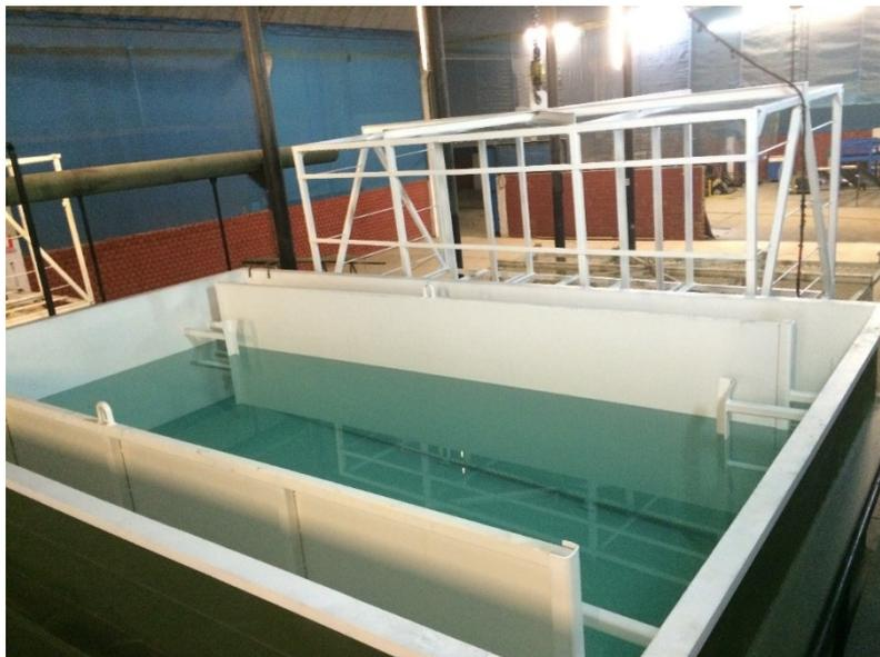
**Figura 20- Tina lista para iniciar proceso de tratamiento hidrotérmico**
