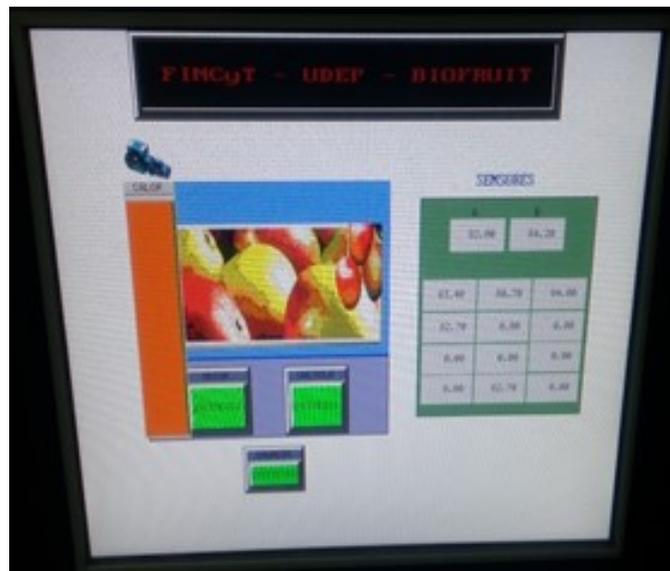
**Figura 19- Panel de control y visualización de temperaturas de tratamiento**
