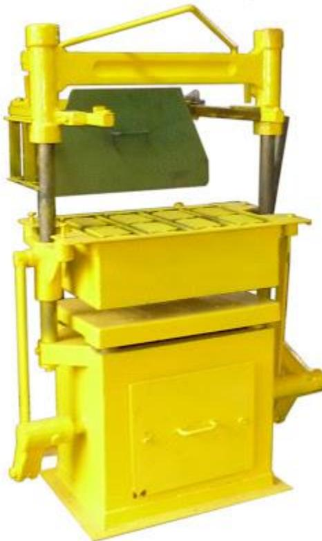
**Ilustración 13: Máquina bloquera tipo rosacometa**
