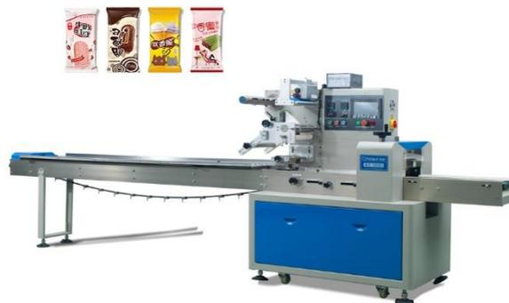
**Nota. La figura nos da una idea de cómo es la máquina de envasado para helados de hielo. Obtenido de Alibaba.**
