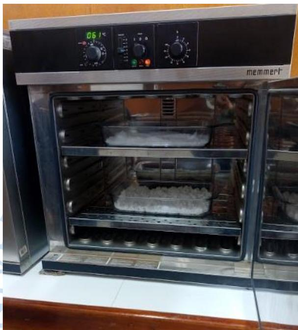
Figura 64. Proceso de secado de la sal en estufa Memmert
