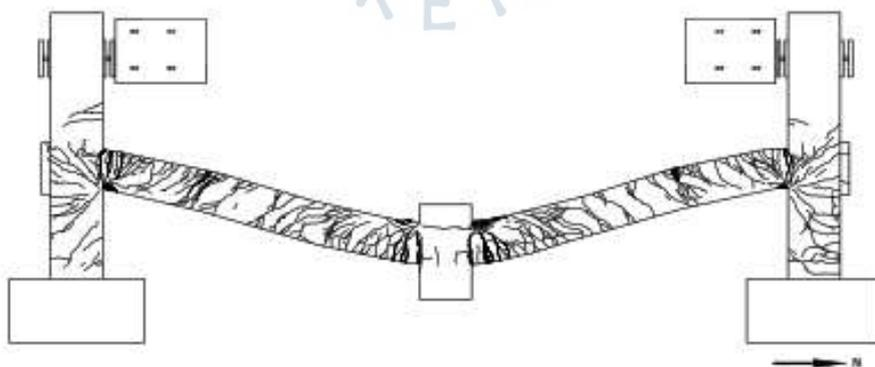
Figura 80. Resultado del modelo numérico de las vigas cerca a la columna central en *Extreme Loading for Structures* utilizando el test SSA1 (separation Strain del acero = 0.10)
