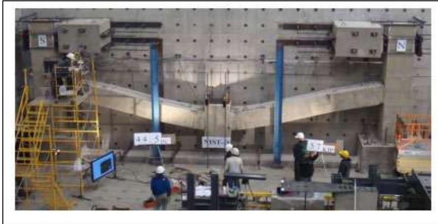
**Figura 46. Desplazamiento vertical final de la columna central del espécimen SMF**
