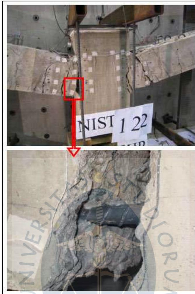
**Figura 42. Modo de falla del espécimen IMF**
