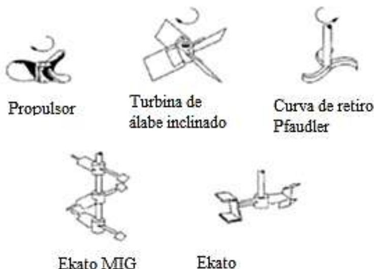
**Figura 12:** Propulsores de flujo axial.
