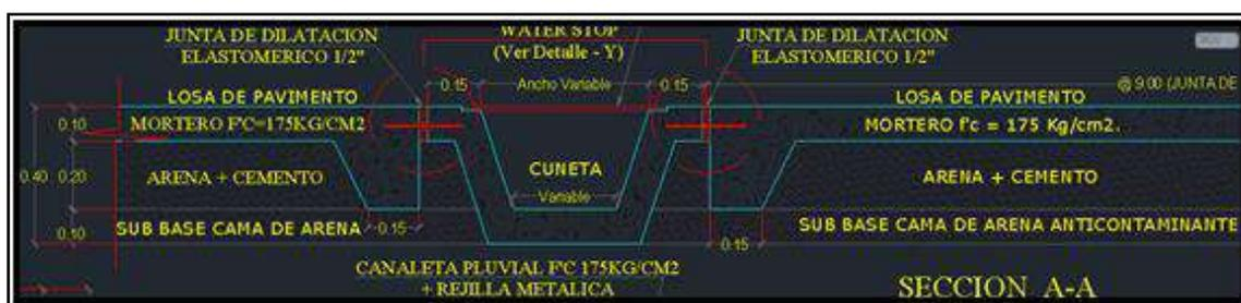
**Figura 12.** Vista de perfil del drenaje pluvial.
