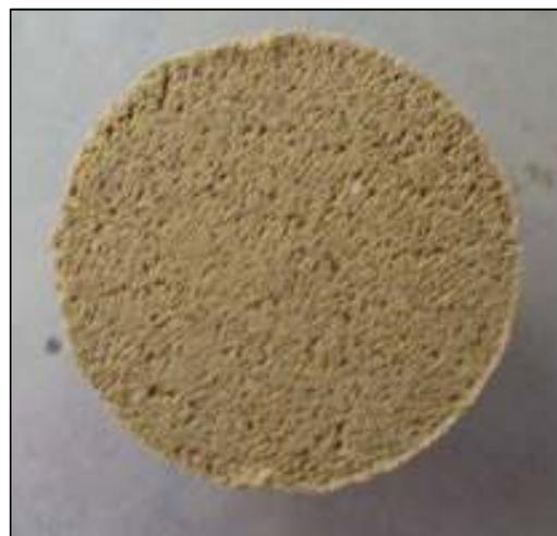
Según los datos medidos y las imágenes mostradas anteriormente podemos decir que una muestra cernida con las características de la arena de *El Porvenir*, tiene que tener un peso dentro del intervalo de 154 – 155gr para obtener una probeta con dimensiones estandarizadas el cual tiene una presión de compactación de 9.5kPa, esto se puede traducir como la caída de una masa de 2.5kg desde una altura de 32.5cm.
