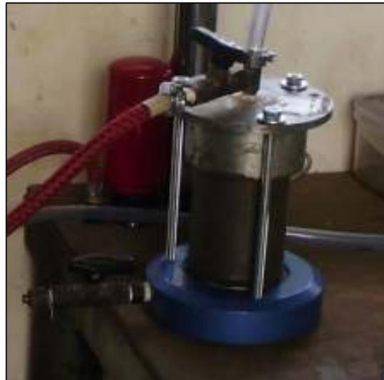
El funcionamiento consiste en entregar el propio volumen de aire del inflador a la cámara de permeabilidad midiendo el tiempo en que esto sucede. Para esto utilizamos pesos colocados estratégicamente en el mango del inflador con tal que este último baje sin
