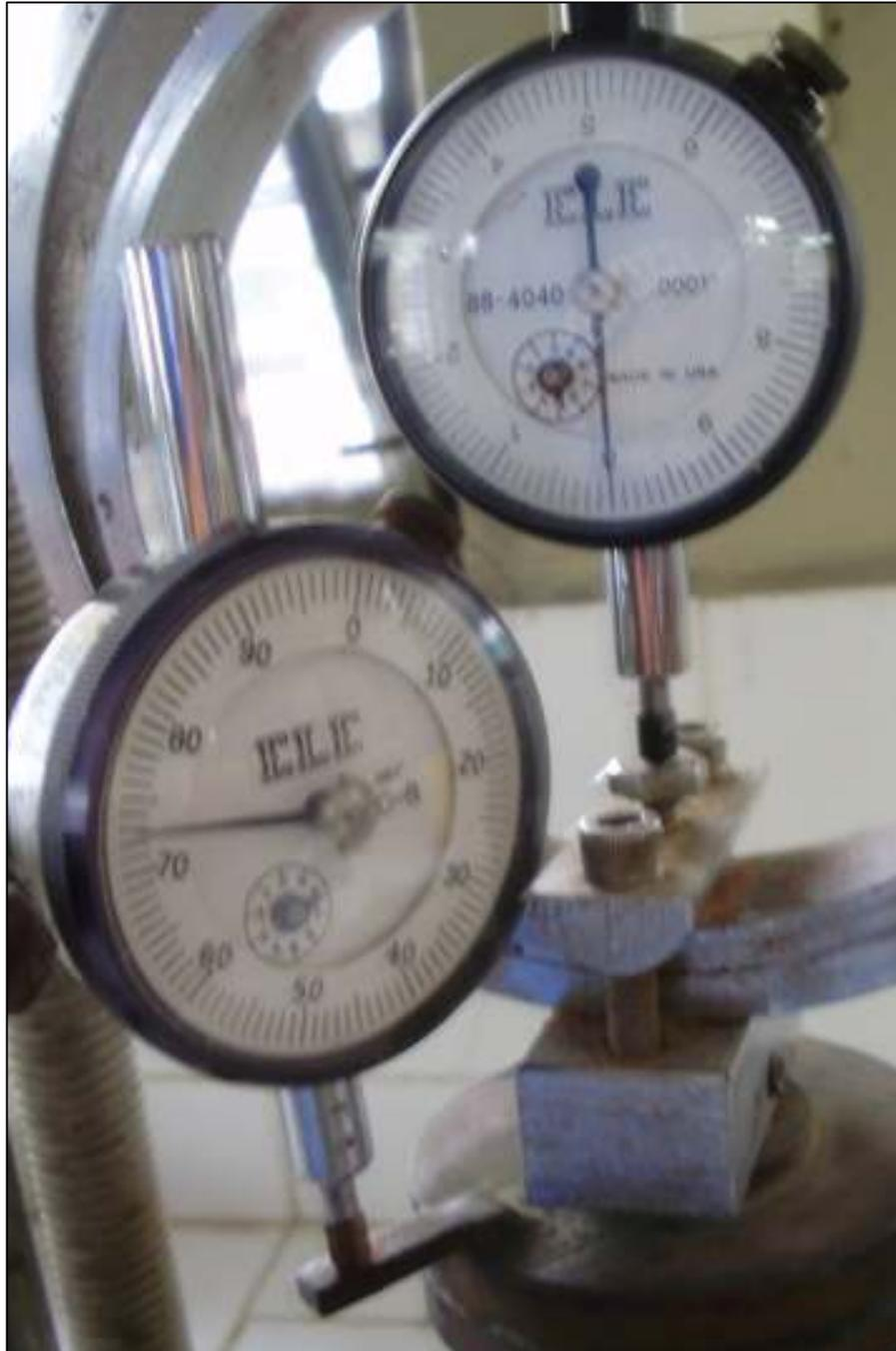
Para la medida de la carga y la deformación, los diales otorgaran datos a su calibración correspondiente. Para la carga se utilizará el dial superior con una graduación de  $0.0001''$  y para la deformación, el dial inferior con una graduación de  $0.001''$ . Ahora el valor del dial que proporcionará la carga, con una medida de  $0.0001''$ , equivale a  $0.44\text{kg}$  según las características del anillo de transmisión.
