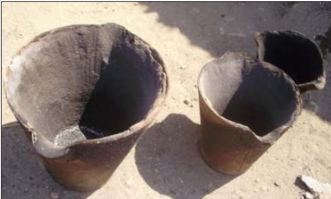
En la figura 4.6 se aprecia cucharones de colada caseros de diferentes tamaños. El diseño del cucharón de colada es simple y el recubrimiento interior no es difícil de conseguir. Gracias a la refractariedad de la arcilla y a su fácil adquisición, la fabricación de los cucharones de colada se realiza en los talleres de la provincia de Sullana.
