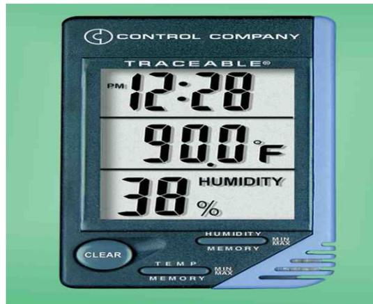
Figura 23. Higrómetro usado para toma de datos en los módulos paneleros de la Sierra de Piura.
