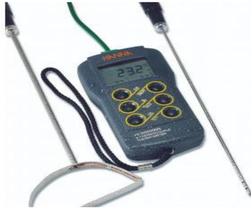
Figura 22. Termómetro usado para toma de datos en los módulos paneleros de la Sierra de Piura.
