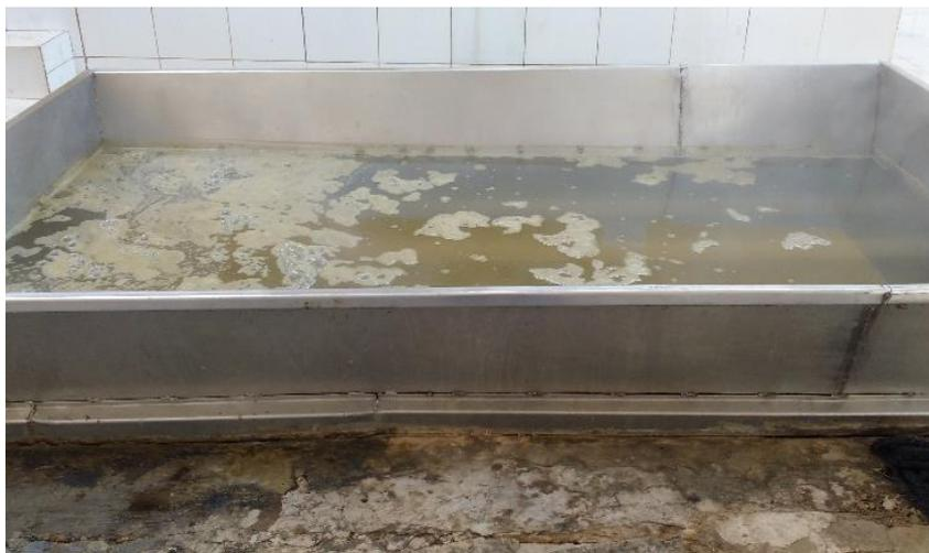
Figura 7. Paila clarificadora del proceso de elaboración de panela.
