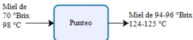
Figura 11. Diagrama de proceso en la etapa de punteo en la elaboración de panela.
