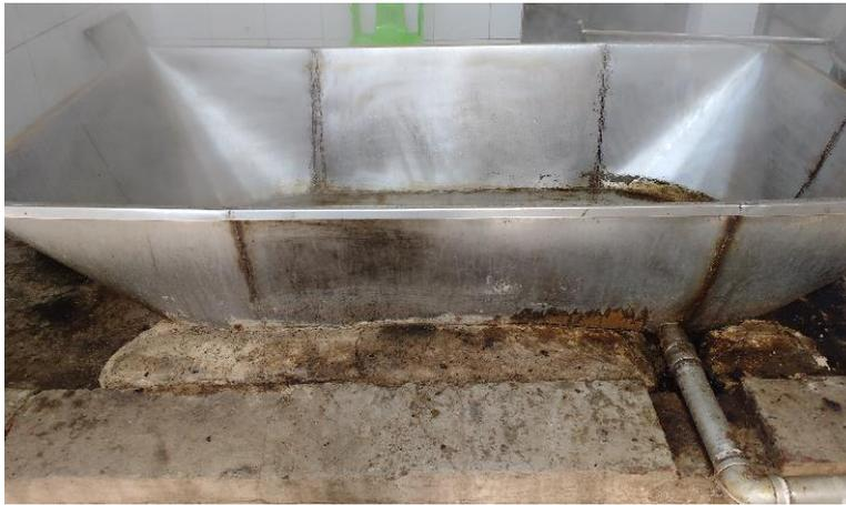
Figura 9. Paila evaporadora del proceso de elaboración de panela.
