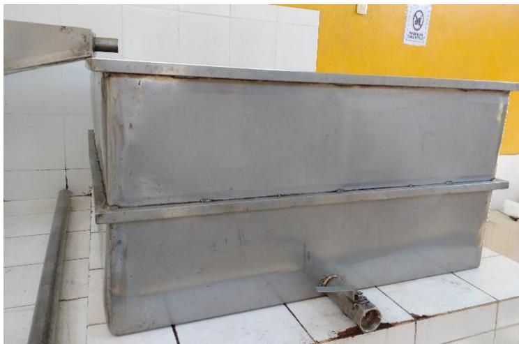
Figura 6. Paila receptora del proceso de elaboración de panela.
