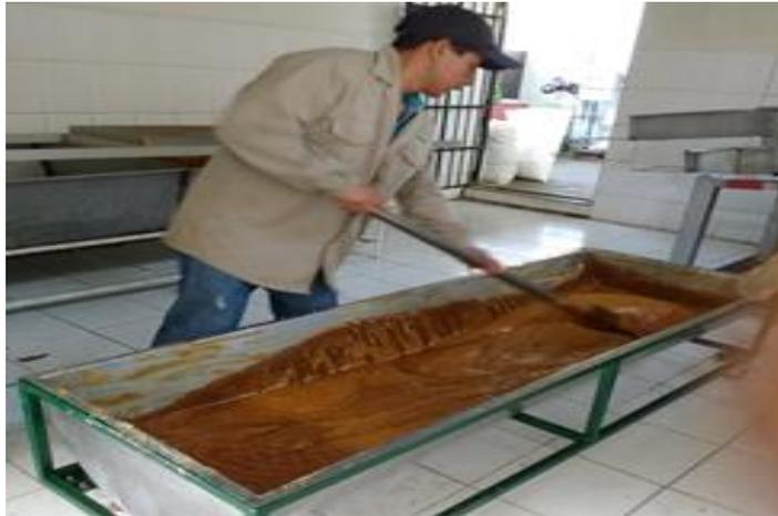
Figura 13. Etapa de batido del proceso de elaboración de panela.
