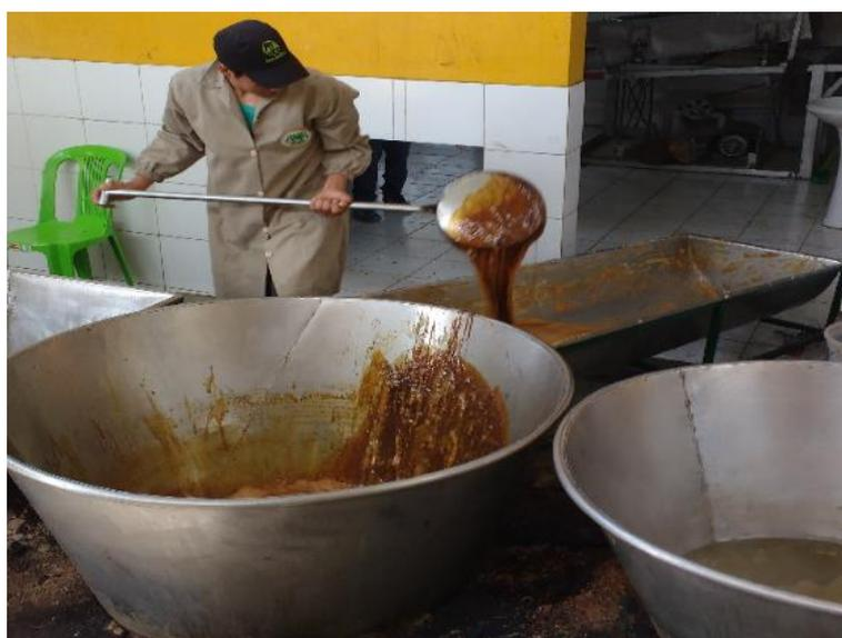
Figura 12. Etapa de punteo en el proceso de elaboración de panela.
