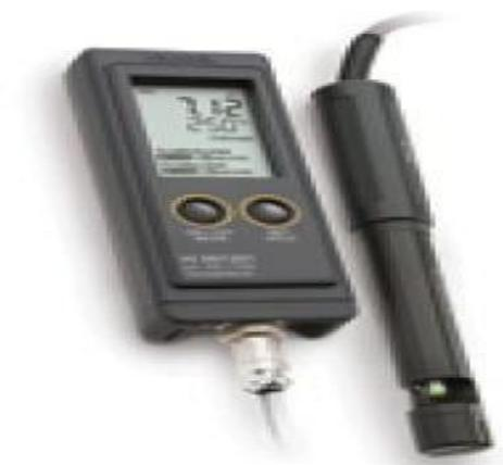
Figura 21. pH-metro usado para toma de datos en los módulos paneleros de la Sierra de Piura.
