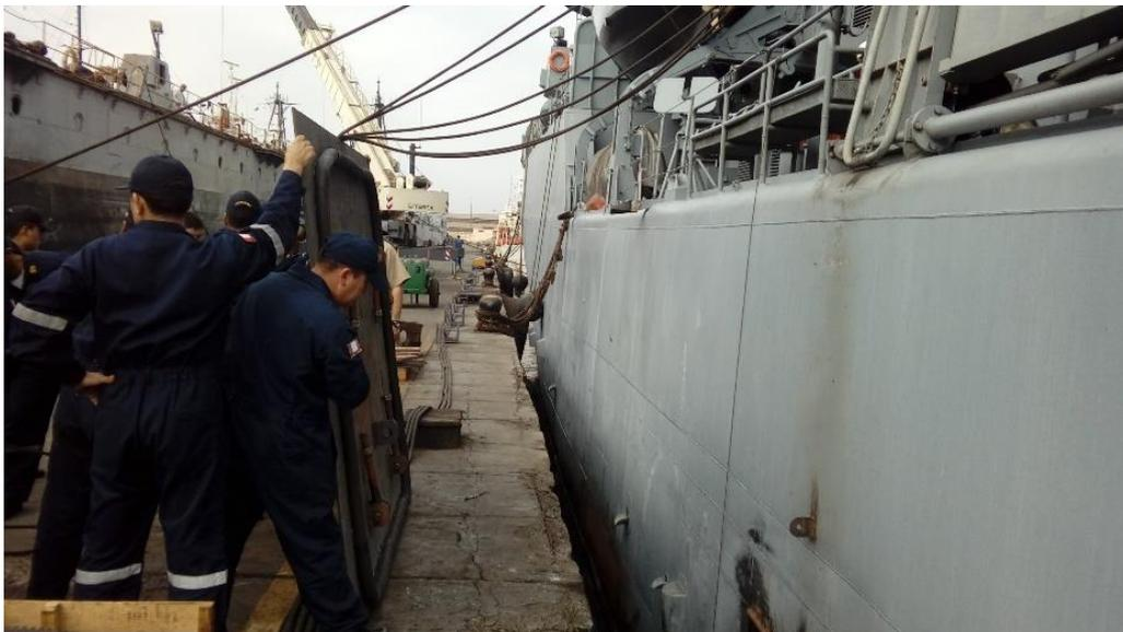
**Figura 3** Grupo de trabajo activado para tapan el forado del casco
