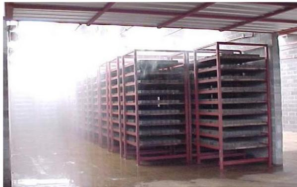
**Figura 11.** Curado de adoquines.
