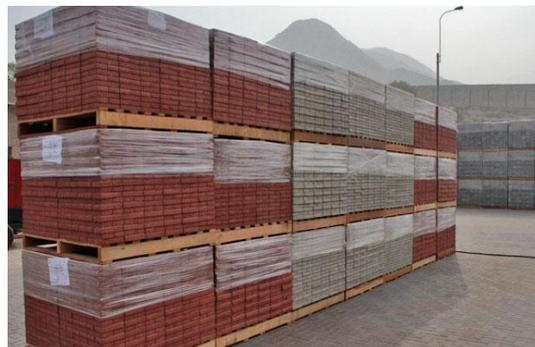
**Figura 12.** Almacenamiento de adoquines
