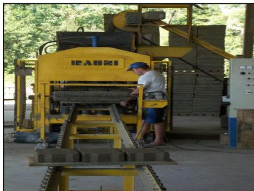
**Figura 20.** Máquina bloquera
