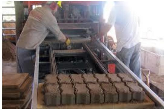
**Figura 9.** Moldeado del adoquín
