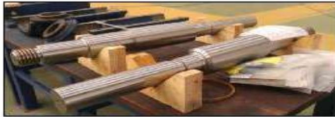
**Ilustración 5 Eje de bomba de pulpa GIW LSA 6x8**
