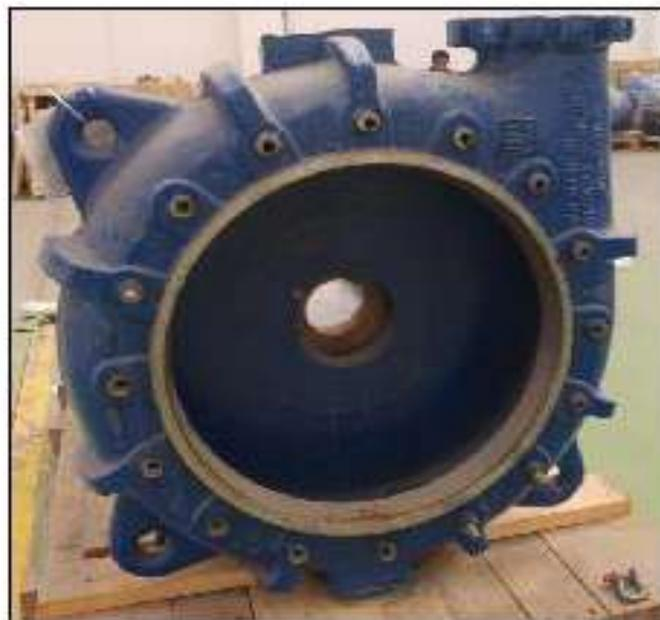
**Ilustración 2 Voluta bomba de pulpa GIW LSA 6x8**
