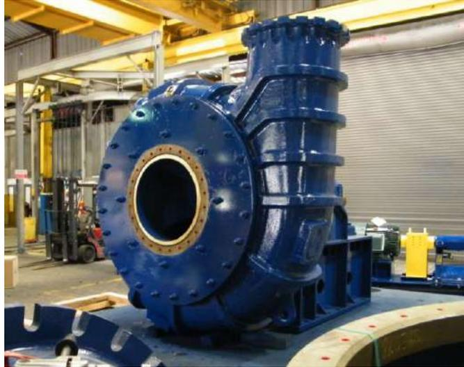
Figura 17: Bomba de pulpa utilizada para la industria minera
