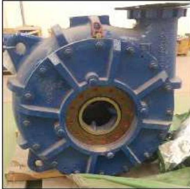
**Ilustración 1 Bomba de pulpa GIW LSA 6X8**
