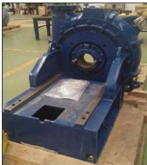
**Ilustración 7 Bancada de bomba GIW LSA 6x8**
