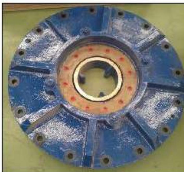
Ilustración 3 Suction plate de bomba de pulpa GIW LSA 6x8
