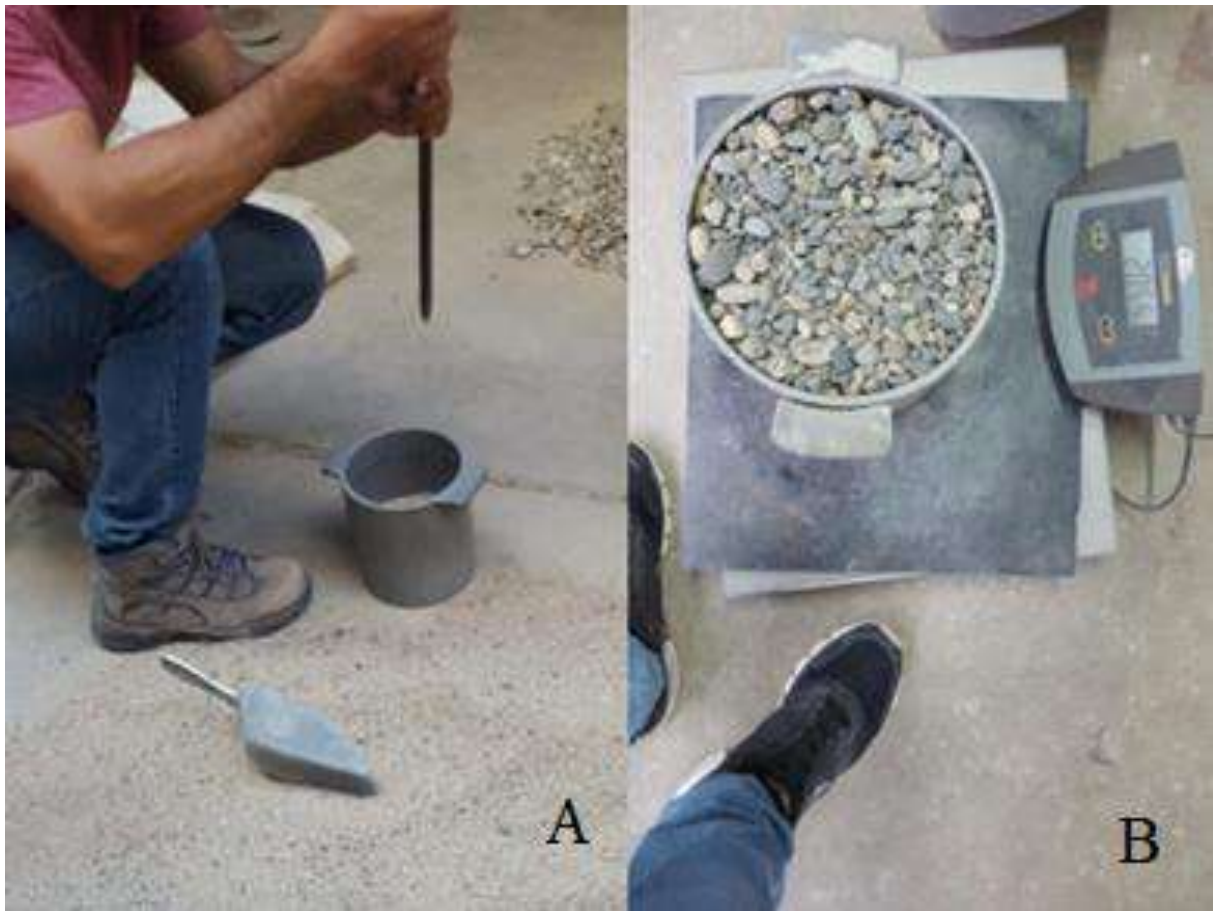
Figura 11. A) Compactación del agregado fino B) Pesaje del agregado grueso después de la compactación.
