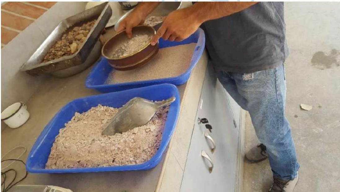
Figura 31. Tamizado del material triturado en el tambor de los Ángeles.
