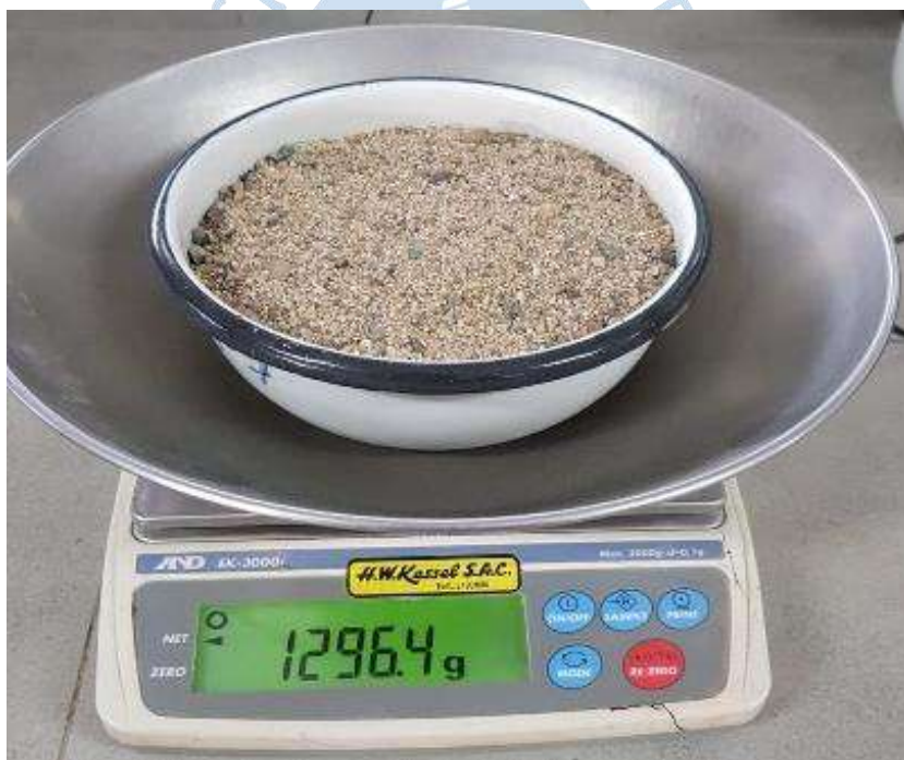
Figura 8. Peso seco al horno de la muestra de agregado fino para posteriormente calcular el contenido de humedad.
