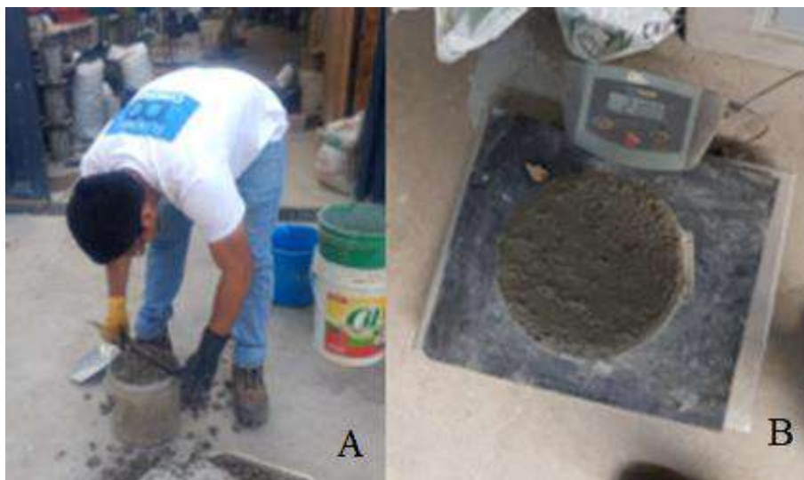
Figura 12. A) Enrasado de la mezcla de concreto B) Pesaje de la mezcla de concreto para posteriormente calcular el peso unitario.
