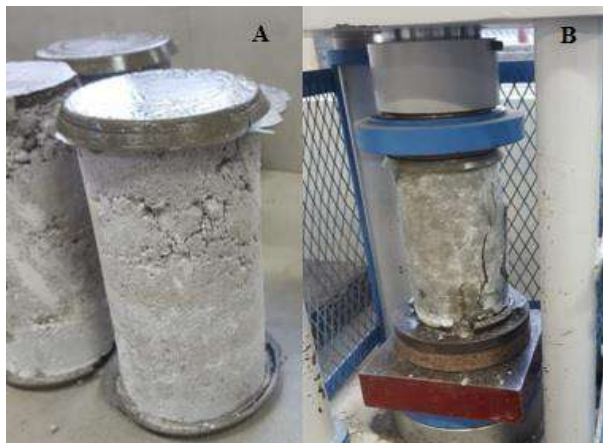
Figura 15. A) Probetas antes de ensayar B) Probetas después del ensayo Fuente: Elaboración propia
