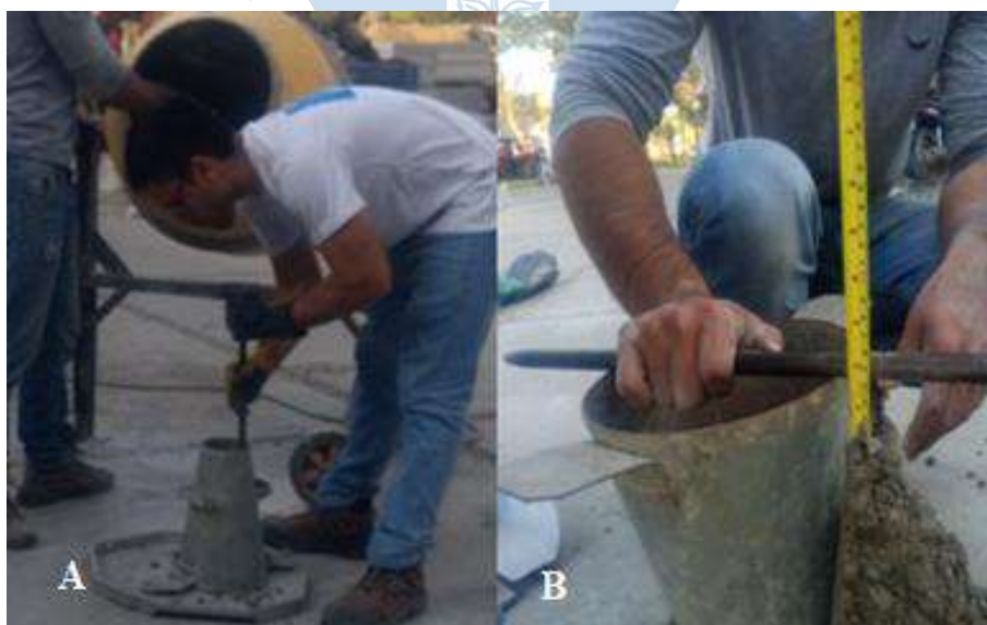
Figura 13. A) Compactación de la mezcla de concreto B) Medición del asentamiento de la mezcla.
