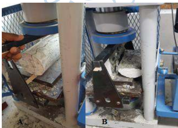
Figura 16. A) Colocación de la probeta de concreto en la compresora B) Rotura de la probeta de concreto. Fuente: Elaboración propia
