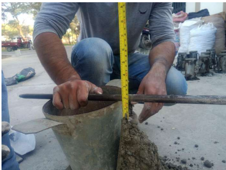
Figura 41. Desmoronamiento del material en la tanda PR40. Fuente: Elaboración propia
