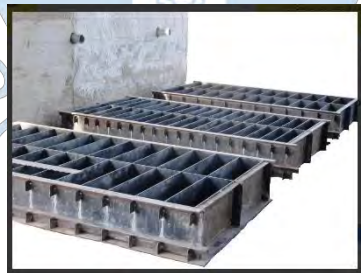
Figura 26. Moldes de concreto
