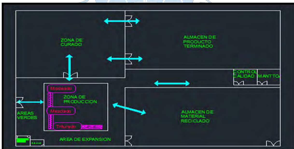
Figura 16. Distribución de maquinaria, equipos y sectores
