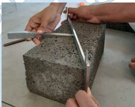
Figura 61. Medición de alabeo para área transversal
