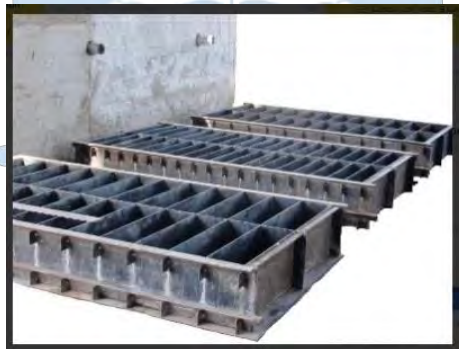
Figura 71. Moldes de concreto
