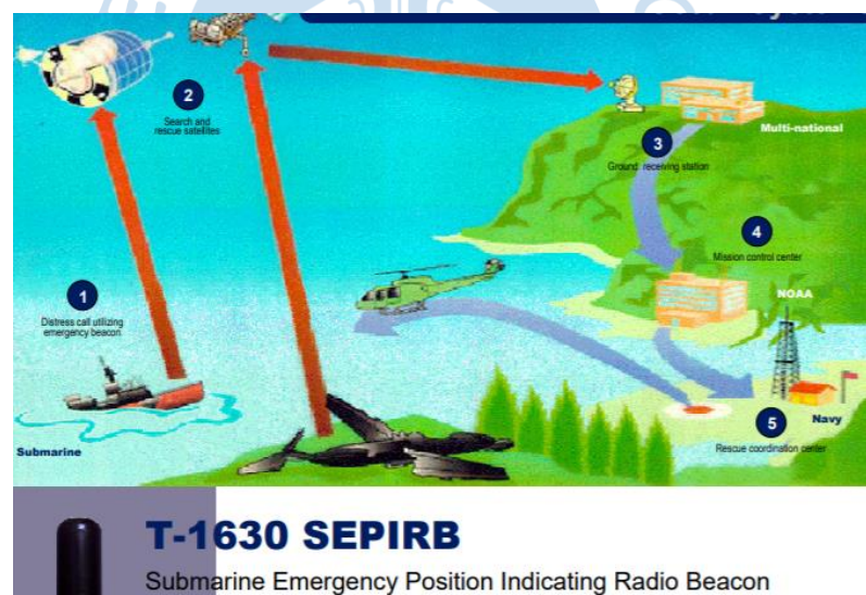
Figura 4 Ruta de emisión y recepción de la señal de emergencia en radiobalizas
