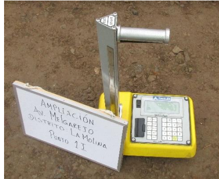
Figura 23. Densímetro nuclear Marca Troxler 3440 Plus
