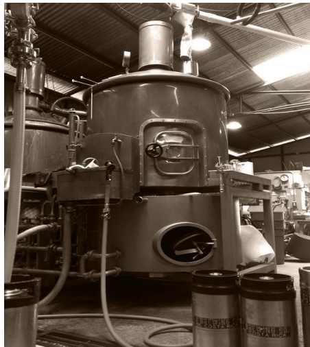
Ilustración 10. Tanque Industrial de cocción del mosto
