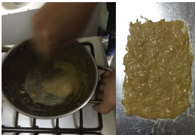
Figura 15: Mezcla y secado de bioplástico
