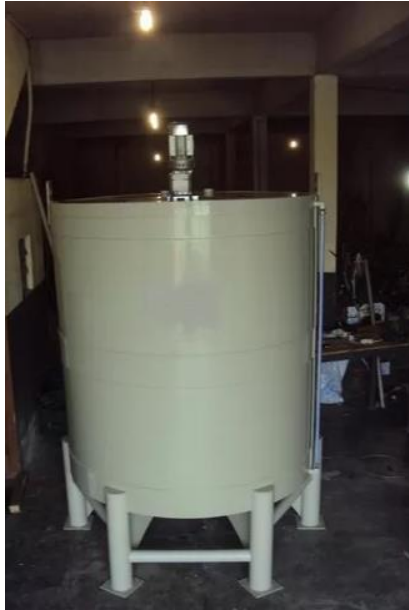
Ilustración 5 Tanque Transesterificación 5000 L Fuente: Mercado Libre Brasil
