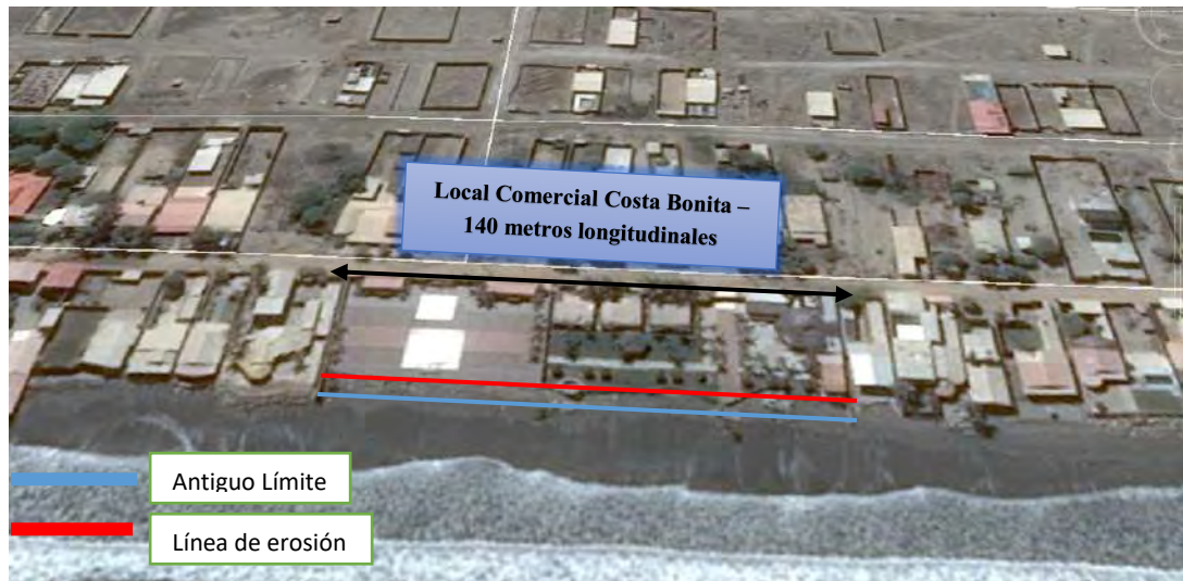
Figura 4. 7. Antiguo límite de estructura y línea de erosión, Fuente: Elaboración propia
