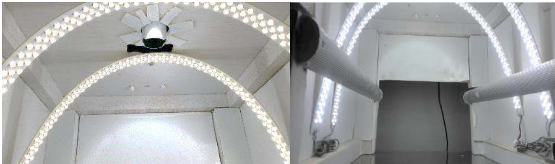
Figura 78. Distribución de iluminación LED en el sistema de adquisición del experimento de análisis de grano de cacao en el espectro visible.
