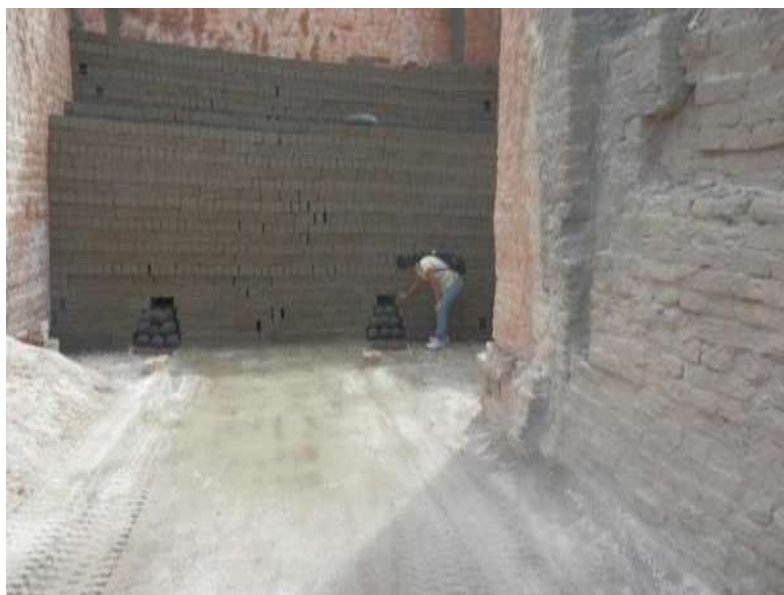
B48. Almacenamiento del adobe previo al proceso de obtención de ladrillos. Fuente: Elaboración propia
