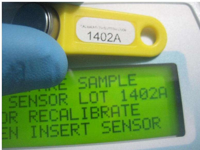
**Figura B-2.** Botón magnético para prendido y calibración de equipo LeadCare II
