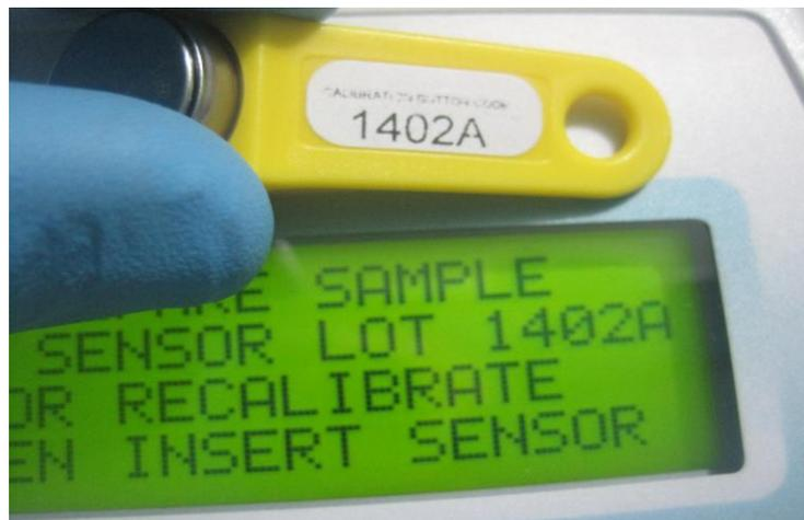
**Figura 5.** Botón magnético para encendido y calibración de equipo LeadCare II
