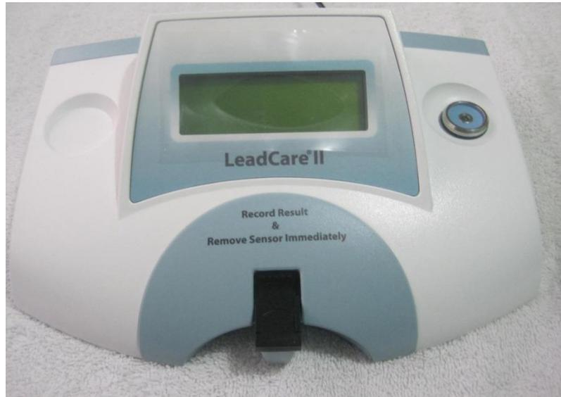
**Figura B-1.** Equipo Analizador de plomo LeadCare II
