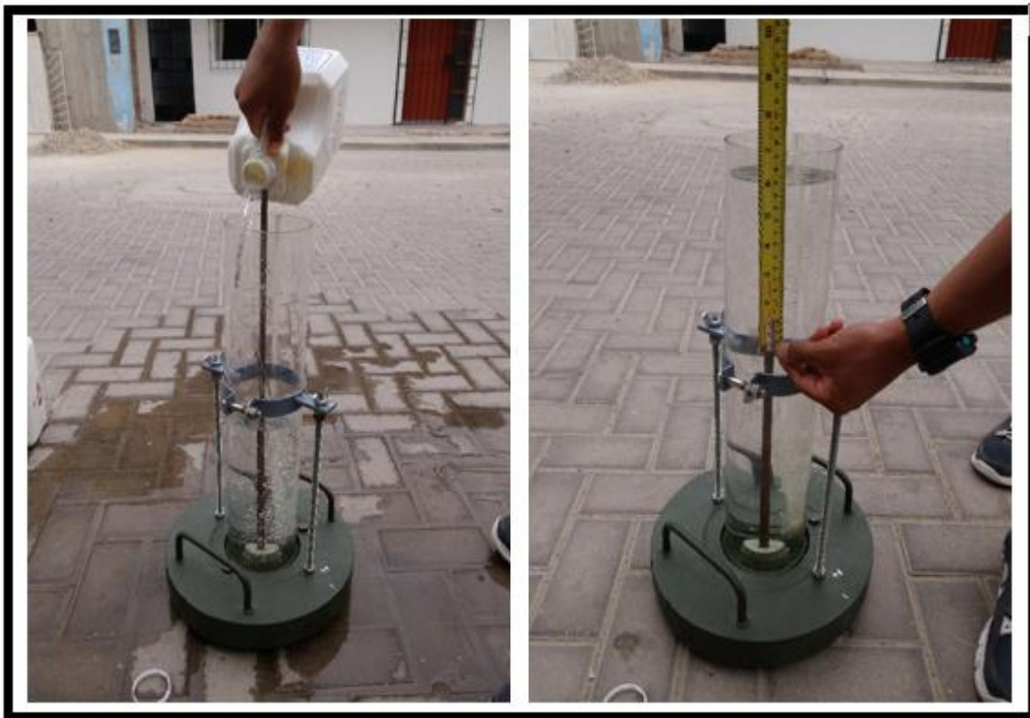
Fig. 3.2. Mediciones de la tasa de infiltración en campo con el uso del permeámetro LCS. (Fuente: Elaboración propia)
