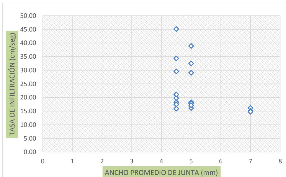
Fig. 4.6. Relación entre el ancho promedio de junta y la tasa de infiltración en la zona 2. (Fuente: Elaboración propia)
