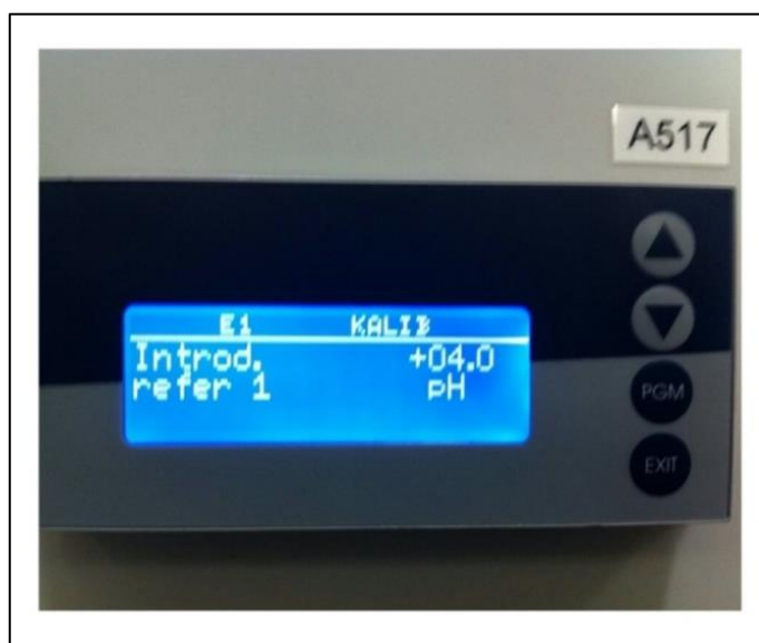
Figura 25 - Paso 7 - Primera solución calibrada pH +4.01
