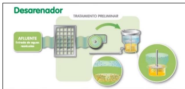
Figura 4 - Filtrado de aguas residuales
