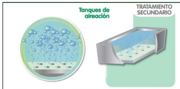
Figura 6 - Tanques de aireación – Reactor biológico
