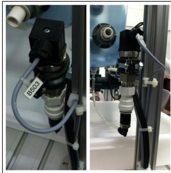
Figura 16 - Sensor analógico de presión B503
