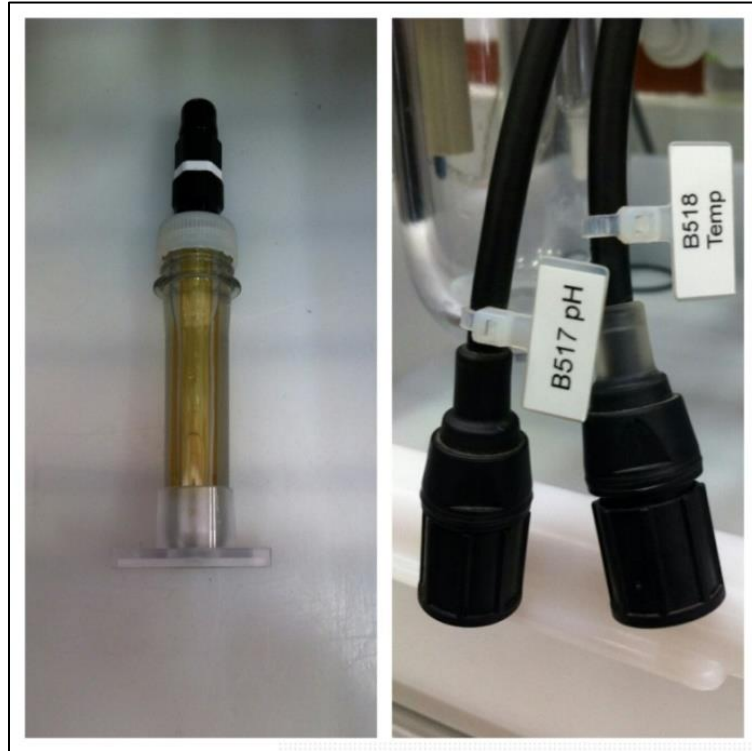
Figura 66 - Electrodo de pH y sondas pre-ensambladas
