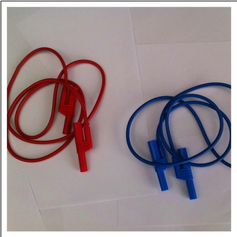
Figura C.7. Cables de alimentación 24 VDC.
