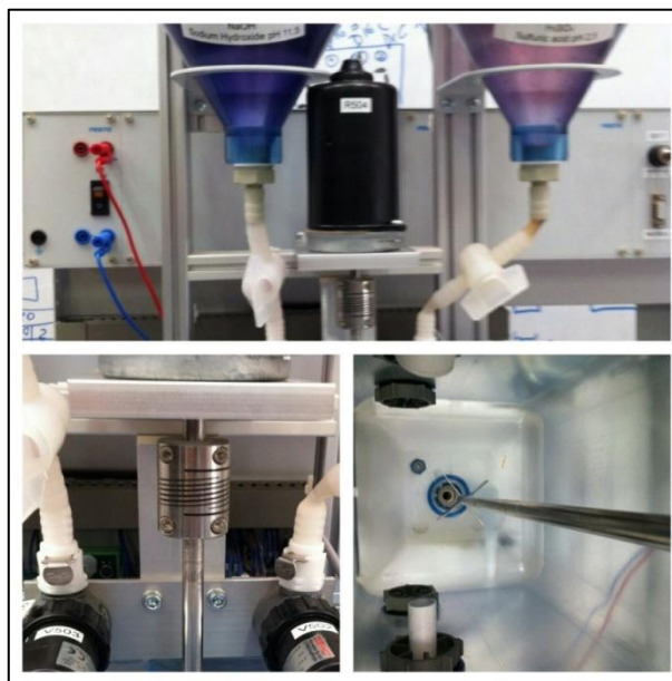
Figura 14 - Componentes del Agitador (motor, acople de compensación y varilla agitadora)
