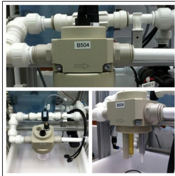
Figura 17 - Ajustador de flujo B504 (sensor de pH, sensor de temperatura)
