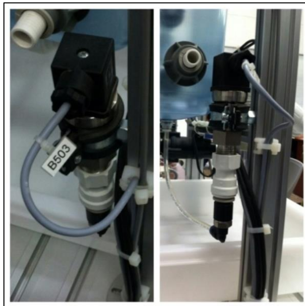
Figura 65 - Sensor analógico de presión B503
