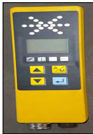
Figura 61. Tablero de control del sistema láser Fuente: MOBA (2015)
