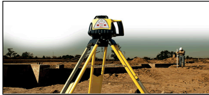
Figura 59. Dispositivo emisor de rayo láser para agricultura y construcción civil
