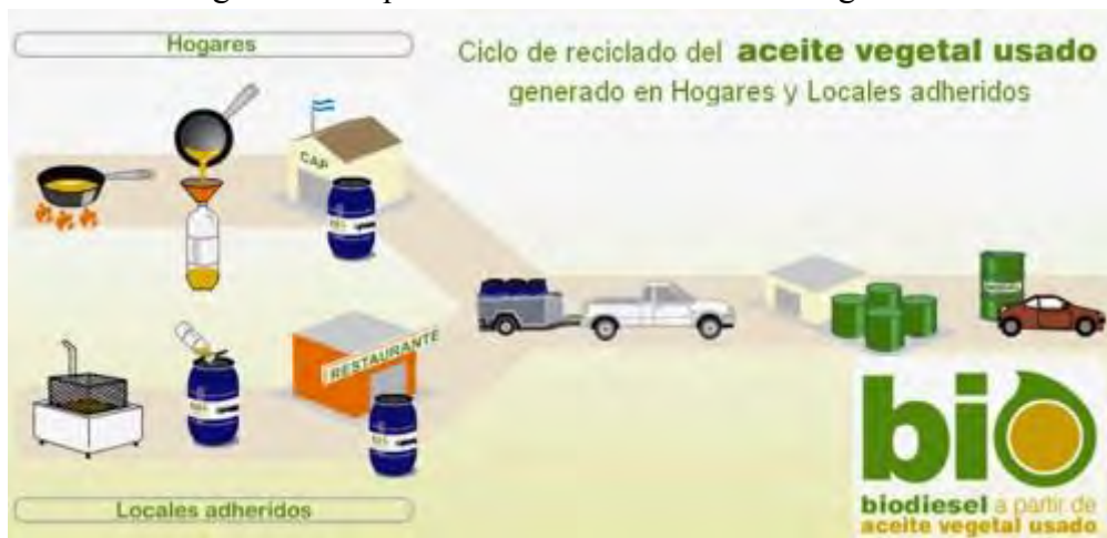
Figura 2.2 Esquema del ciclo de los aceites vegetales usados
