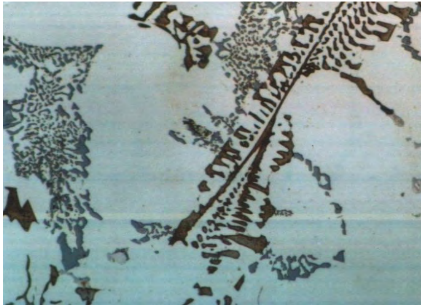
Figura 5.8.d. Ataque por 2 minutos 45 segundos. Aumento 1000X.
