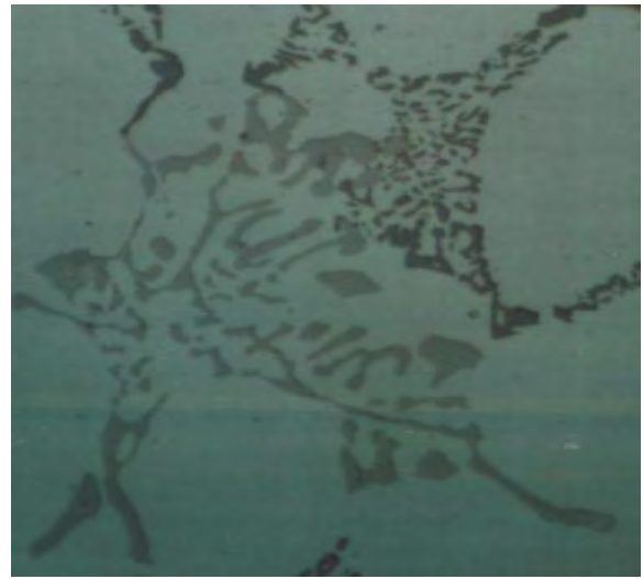
Figura 5.5.c Chinescas sin ataque Aumento 1000 X.
