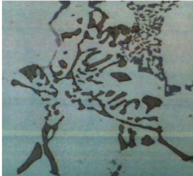
Figura 5.8.a. Ataque durante 2 minutos. Aumento 1000X.
