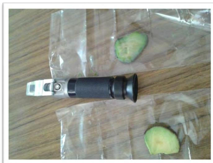
Ilustración 26 Medición de grados Brix
