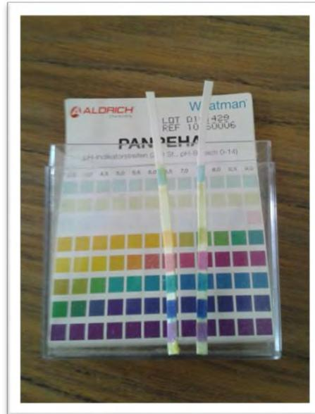
Ilustración 27 Medición de PH en la palta
