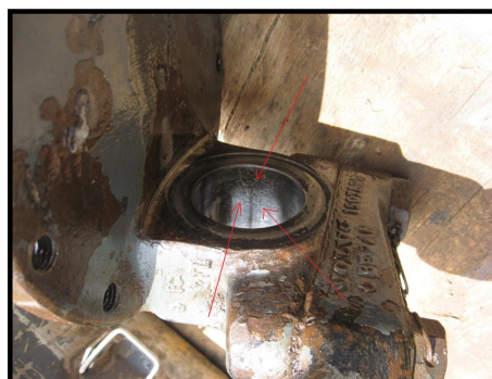
Foto 4.1: Presenta desgaste en los pines. Foto 4.2: Presenta desgaste en el alojamiento de la bocina.
