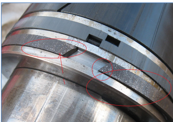
Foto 4.5: Presencia de partículas metálicas en los sellos debido a que el vástago ha tenido contacto irregular con la superficie del cilindro.
