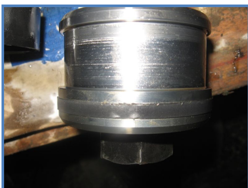
Foto 4.3: Presenta deterioro en los sellos hidráulicos.
