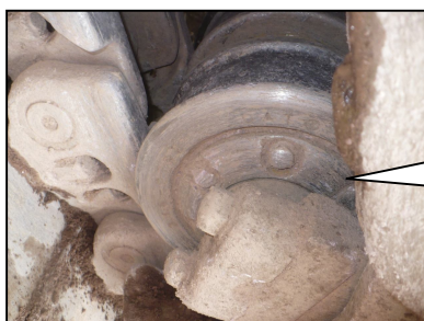
Foto 5.2: Estado de rodillo inferior del tractor D8T-1009TO-Serie: J8B00332, en el mes de enero-2011.
