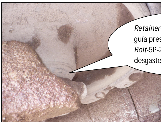
Foto 5.3: Estado de rueda guía del tractor D8T-1009TO-Serie: J8B00332, en el mes de enero-2011.
