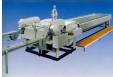
Fig.2.5. Enlatadora automática Fuente: Mi blogs - Selladoras de Lata en Industria de Alimentos
