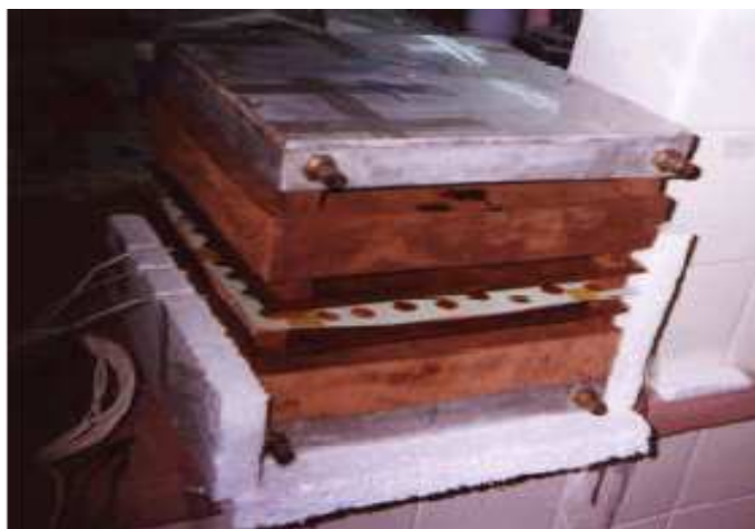
Figura 2.13. Vista de perfil del aparato con las muestras a medir.
