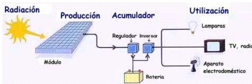
Fig. 1.5: Una instalación solar fotovoltaica con inversor, utilización a 230Vca
