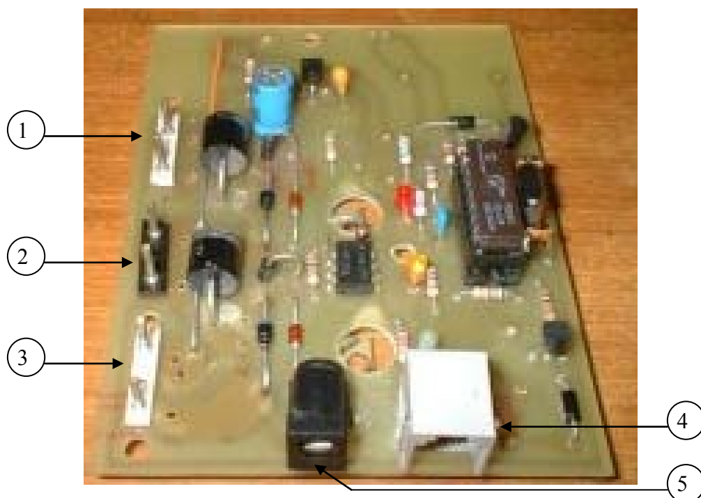
Fig. 5.1: Regulador de Tensión internamente
