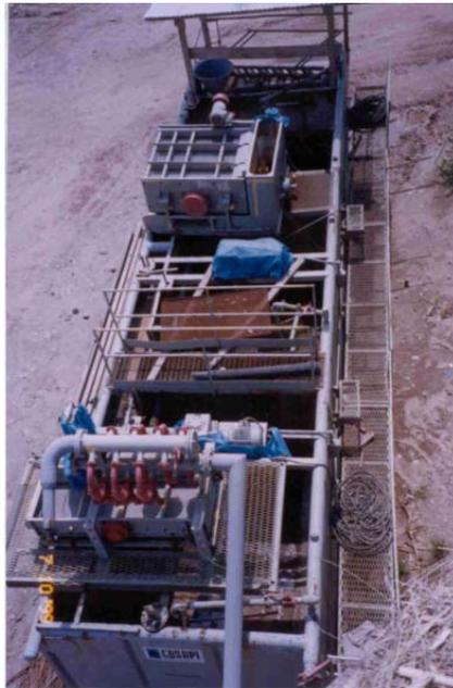
**Figura 3.17** Planta de lodo bentonítico.
