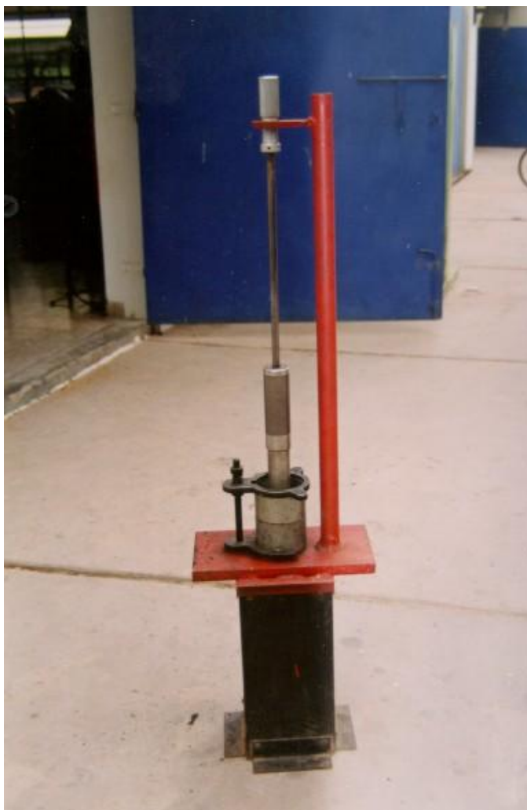
Figura 4.7. Equipo de compactación: base, martillo y molde.
