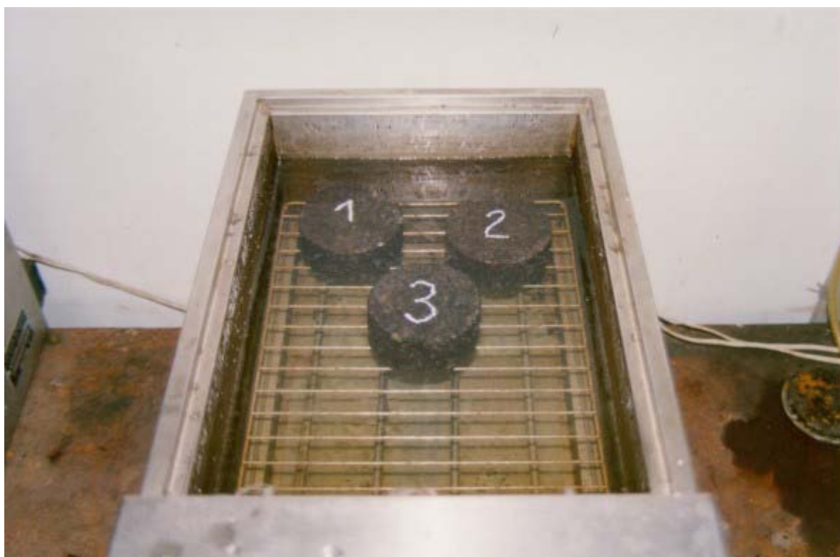
Figura 4.9. Muestras sometidas a inmersión en un baño de agua
