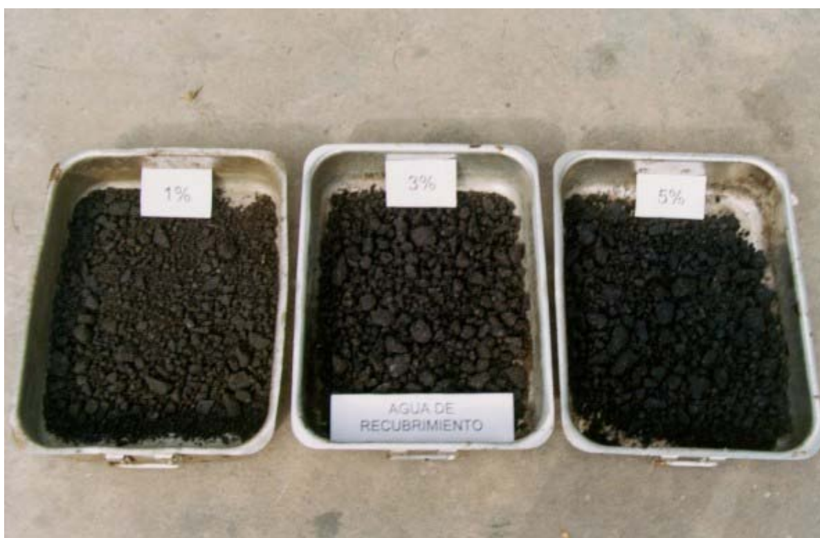
Figura 4.23. Recubrimiento del agregado para distintos contenidos de agua
