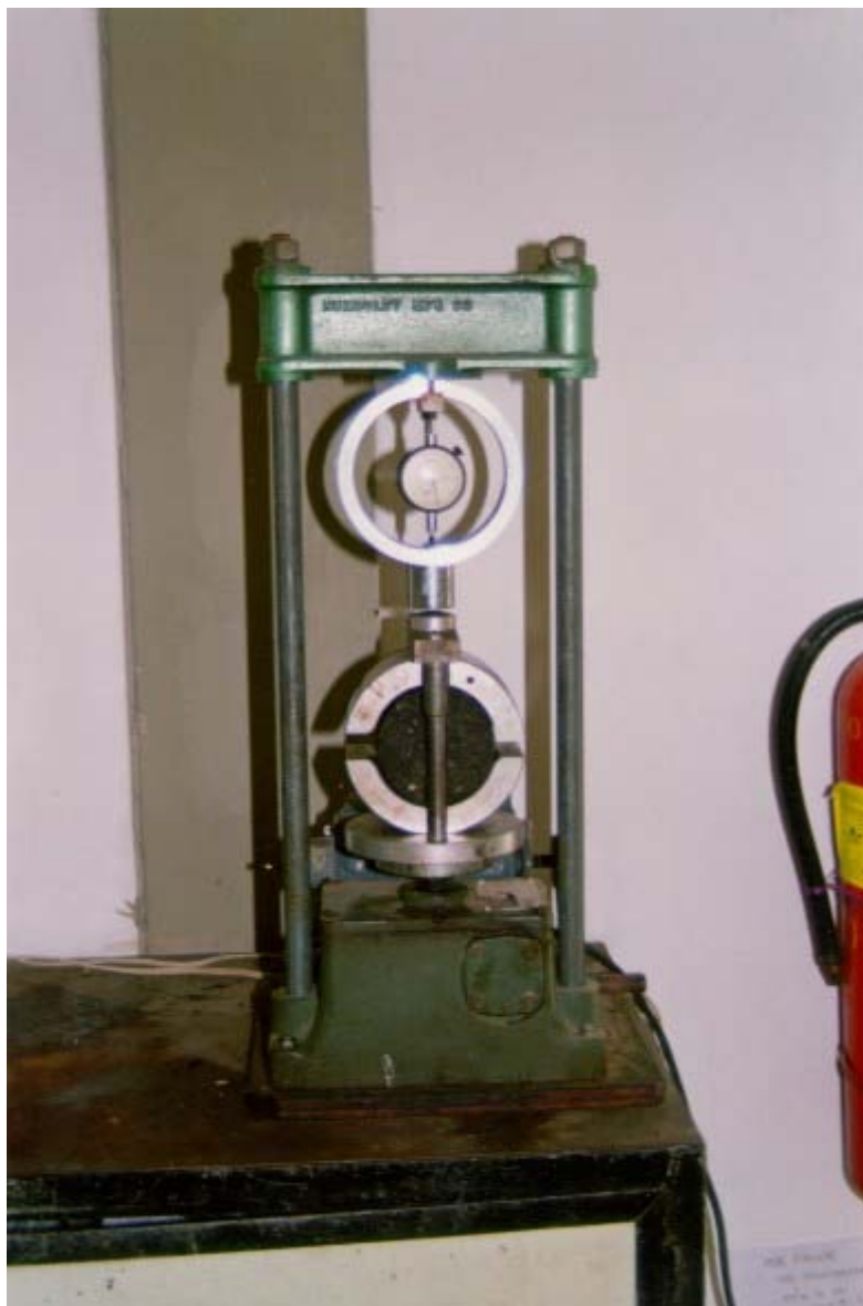
Figura 4.8. Equipo para determinar la estabilidad y flujo Marshall
